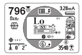
Falls mehr als ein Bluetooth-fähiger SeekTech Transmitter vorhanden ist, drücken Sie die Pfeil nach links-Taste • um durch die verfügbaren Transmitter zu schalten. Drücken Sie die Seriennummer, die unter dem Transmitter-Symbol aufgelistet wird, um den Transmitter zu identifizieren, den Sie steuern möchten.
