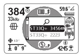
Sobald eine Verbindung hergestellt wurde, stellt sich der Transmitter automatisch an. Wenn verbunden, ist das Bluetooth-Symbol ® am Bildschirm des Transmitters sowie des Empfängers sichtbar. Am Transmitter bestätigt ein Kettengliedbild das die beiden Geräte miteinander verbunden sind.
