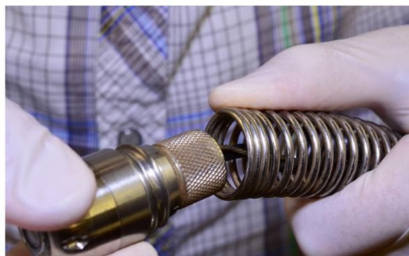
5. Enrosque el resorte en la cámara hasta que el extremo del resorte esté al ras del cabezal de la cámara.
