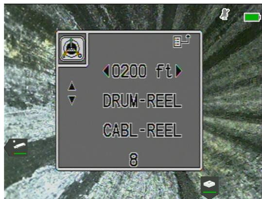
4. Use las teclas Direccionales **◀▶** para cambiar la longitud del cable de empuje.
