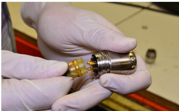
2. Deslice la abrazadera de cierre del cable de empuje sobre la cámara.
