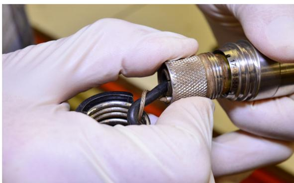
4. La sonda girará al enroscar la cámara en el resorte. Rote la cámara una vuelta en contra de las manecillas del reloj para contrarrestar la torcedura y luego enroscar en el resorte.
