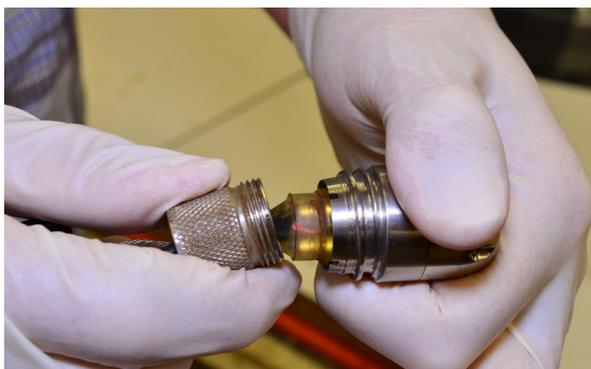
3. Para asegurar que los cables de seguridad queden relativamente derechos cuando usted atornille la cámara en el resorte, gire para atrás la cámara aproximadamente 1 ½ vueltas (como las manecillas del reloj).
