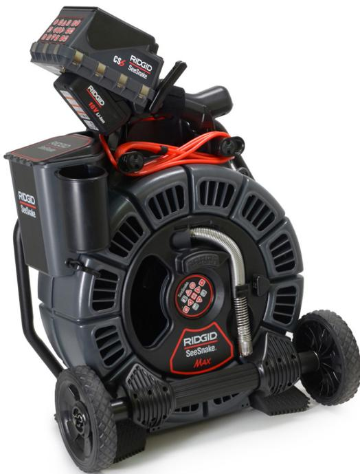
Cada modelo rM200 incluye una sonda integrada que ayuda a localizar problemas en el tubo. El rM200A y el rM200B tienen una sonda FleXmitter® dentro del ensamblado de resortes. Las sondas FleXmitter tienen antenas más largas, más poderosas, capaces de lograr una señal más fuerte sin inhibir la flexibilidad de la cámara en las curvas. La sonda transmite una señal de 512 Hz, la cual puede ser detectada por receptores, tales como el RIDGID SeekTech® SR-20, SR-24, SR-60, Scout™, o el NaviTrack® II.
