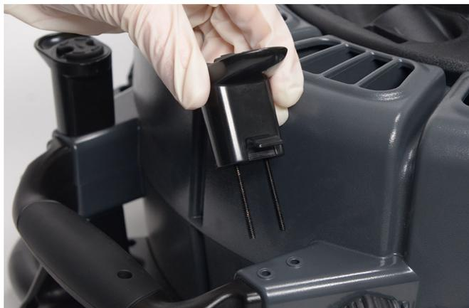
5. Deslice todos los seis deslizadores hacia la manija para abrir la caja del rM200.
