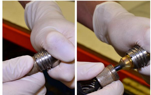
5. Retire la cámara del enchufe de la sonda.
