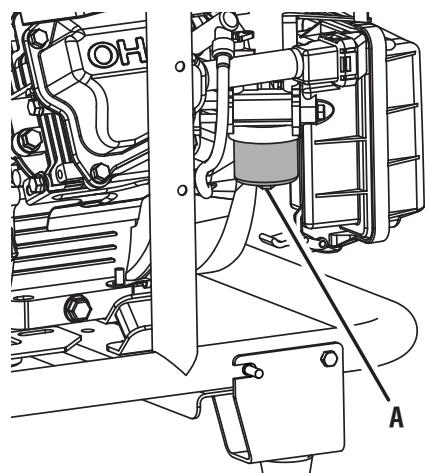
A - Carburetor drain screw (vis de vidange du carburateur, tornillo de drenaje del carburador)
