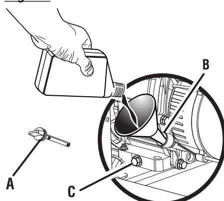
**A - Oil cap/dipstick (bouchon/ jauge d'huile, tapa de relleno de aceite/varilla medidora de aceite)**
