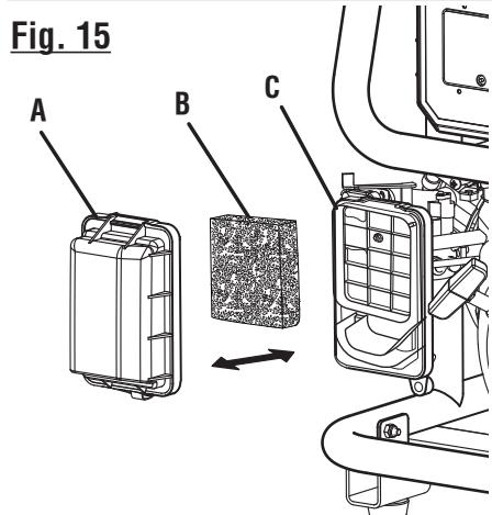
**A - Air filter cover (couvercle du filtre à air, tapa del filtro de aire)**
