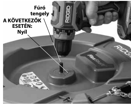
4. Ábra – A fűrógép csatlakoztatása a fűrtengelyhez
