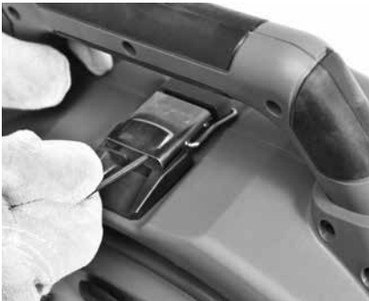
Abbildung 14 – Verschluss unter dem Tragegriff öffnen (mit Sechskantschlüssel)
