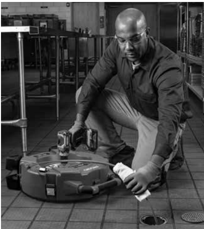
Figuur 13 – Smeermiddel aanbrengen op de veermantel
