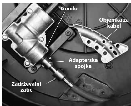
Slika 15 – Odprto ohišje naprave za čiščenje odtokov
