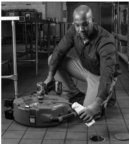
Slika 13 – Nanošenje maziva na izolaciju sajle
