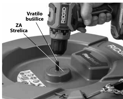
Slika 4 – Postavljanje bušilice na vrtilo
