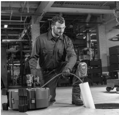
Kuva 5 – Esimerkki viemäriaukon pidentämisestä 3' päähän koneen jousiaukko
