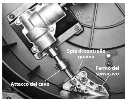
Figura 16 – Sostituzione del Gruppo del cavo
