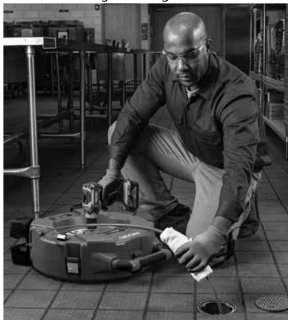
Figur 13 – Påføring af smøremiddel på spiralkappen
