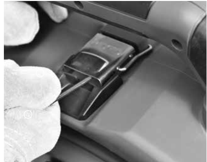
14. Ábra – Hordfogantyú alatti retesz nyitása (hatszögkulccsal)
