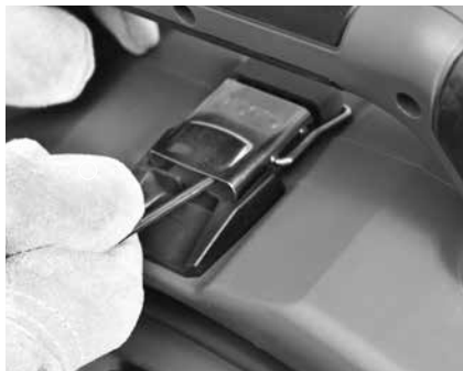
Obrázok 14 – Otvorenie západky pod držadlom (pomocou šesťhranného kľúča)
