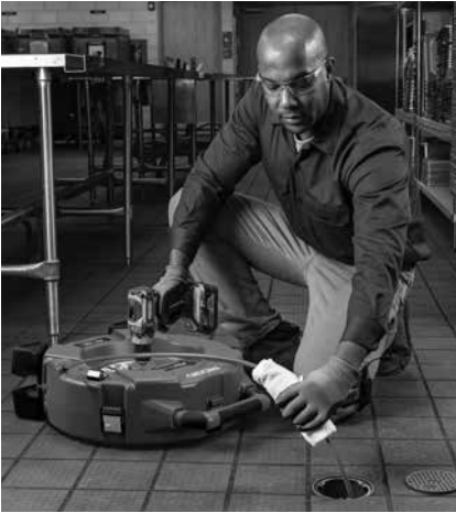
Figur 13 – Applicera smörjmedel på spiralhöljet
