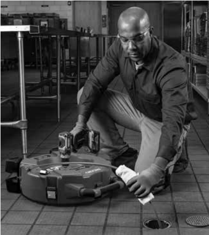
Obrázek 13 – Aplikace maziva na kabelové pouzdro
