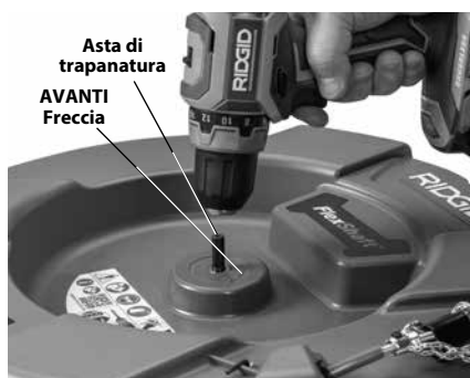
Figura 4 – Collegamento del trapano all'asta di trapanatura
