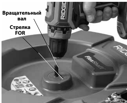
Рис. 4 - Крепление дрели к вращательному валу
