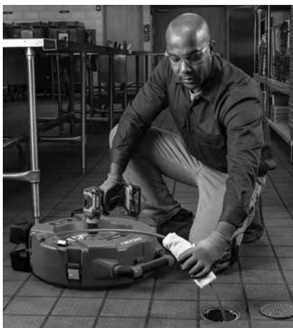
Obrázok 13 – Nanášanie maziva na plášť kábla
