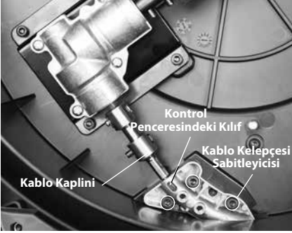
Şekil 16 – Kablo Grubunun Değiştirilmesi
