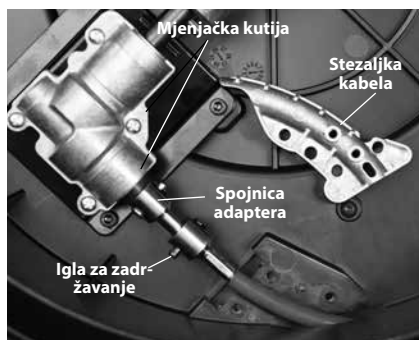
Slika 15 – Otvoreno kućište čistača odvoda
