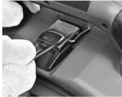
Рисунок 14 – Откройте защелку под ручкой для переноски (используйте шестигранный ключ)
