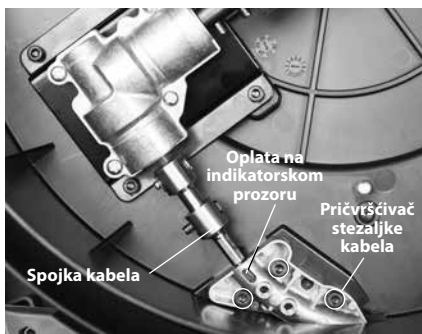
Slika 16 – Zamjena sklopa kabela
