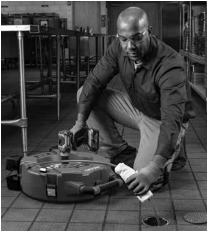
Figura 13 – Applicazioni di lubrificante nella Guaina del cavo
