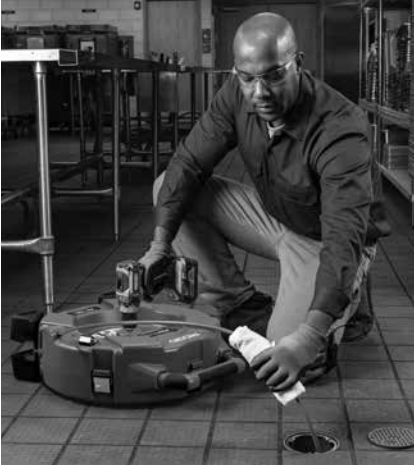
Şekil 13 – Kablo Kılıfına Yağlama Maddesi Uygulama
