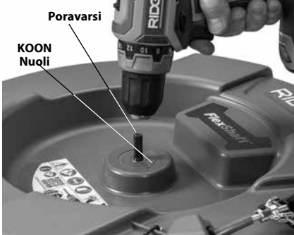
Kuva 4 – Poran kiinnittäminen pora-akseliin
