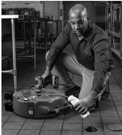
Figure 13 – Application de lubrifiant sur la gaine du câble
