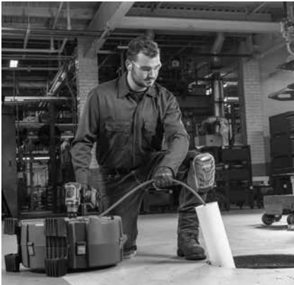
Şekil 5 – Makinenin Kablo Çıkışının 3' İçerisine Kanallı Erişimine Doğru Uzatılmasının Örneği
