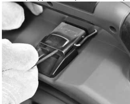
Rysunek 14 – Otworzyć zatrzask pod uchwytem do przenoszenia (użyć klucza sześciokątnego)
