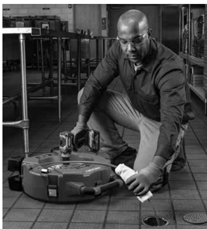
Slika 13 – Nanošenje maziva na oblogu sajle
