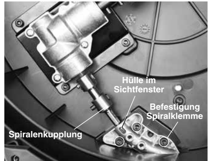
Abbildung 16 – Wechseln der Spirale
