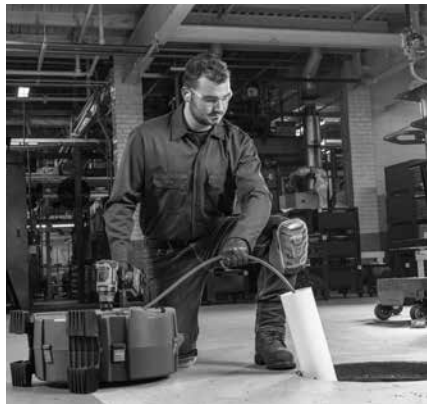
5. Ábra – Példa a lefolyócső hozzáférési pontjának meghosszabbítására, hogy az 3' távon belül legyen a gép kábalkimenetétől
