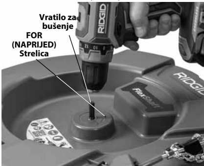
Slika 4 – Postavljanje bušilice na vratilo za bušenje
