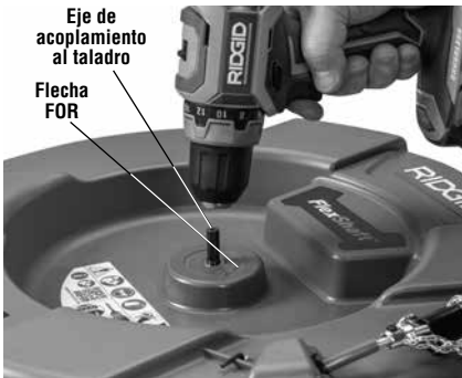
Figura 4 – Conexión del taladro al eje de acoplamiento
