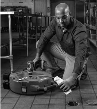
13. Ábra – Kenőanyag felvitele a kábelköpenyre
