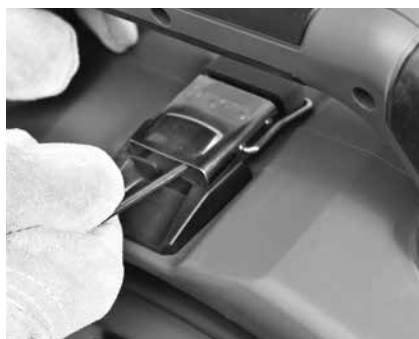
Figur 14 - Åpne låsen under bærehåndtaket (bruk sekskantnøkkel)
