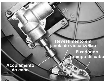
Figura 16 – Substituir o conjunto do cabo
