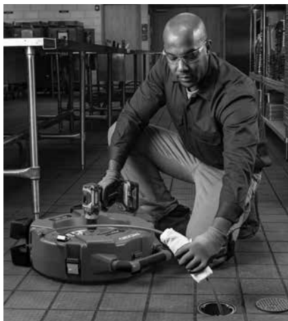
Figura 13 – Aplicar lubrificante ao revestimento do cabo
