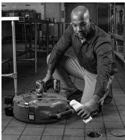
Slika 13 - Nanašanje maziva na ovoj kabla
