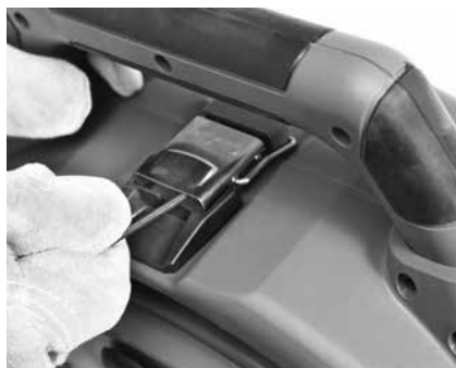
Figur 14 – Öppna spärren under bärhandtaget (använd sexkantsnyckeln)
