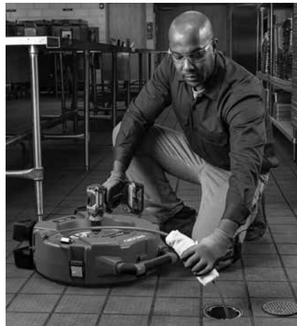
Рис. 13 - Нанесение смазки на оболочку троса
