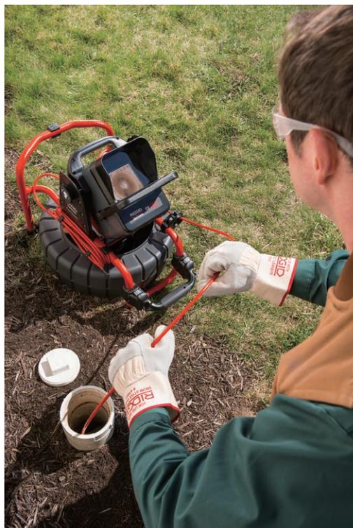
適応径管 38~150mm、ケーブル長 30m
