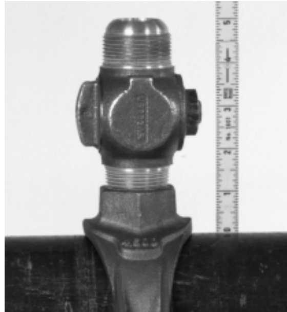
Figura 8 – Medición de la distancia de alejamiento de la válvula
