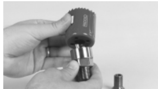
Figura 4a – Montaje de la cortadora en el árbol para sierra de orificio grande
