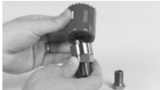
Figure 4a – Installation de la mèche sur l'arbre de grande scie à cloche
