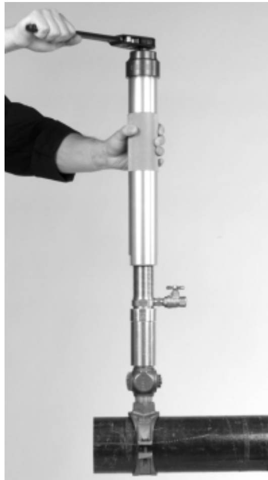
Figure 12 – Pivotation d'une main sur le cliquet et de l'autre sur l'appareil.
