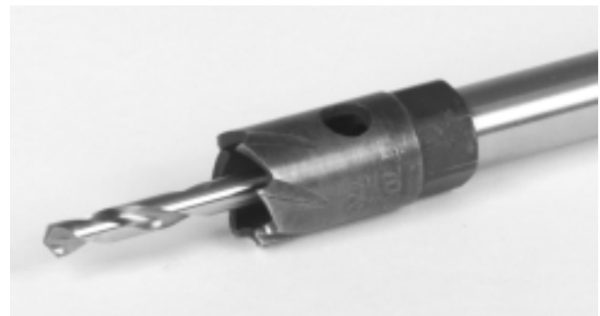
Figure 5 – Installation de la mèche pilote
