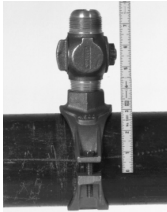
Figure 9 – Relevé du décalage de la vanne.
