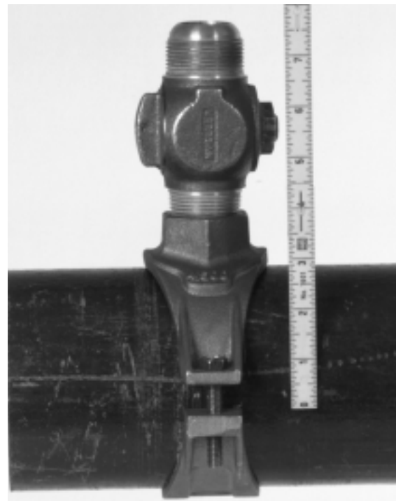
Figura 9 – Medición de la distancia de alejamiento de la válvula
