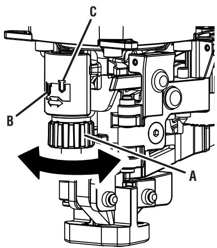
A - Drive depth adjustment (réglage de profondeur d'enfoncement, ajuste de la profundidad de introducción)
