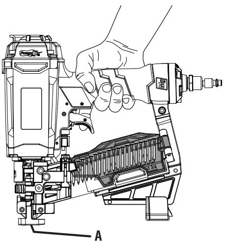
A - Workpiece contact (contact de déclenchement, disparador de contacto)
