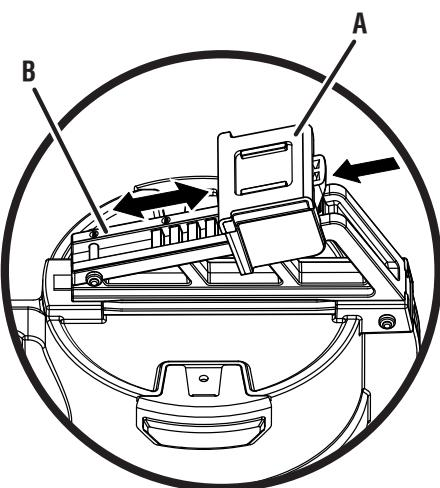
A - Shingle guide (guide de mesure de bardeau, guía para medición de tejas)
