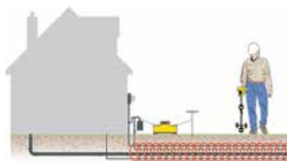
Forbind direkte til forsyningsledninger.
