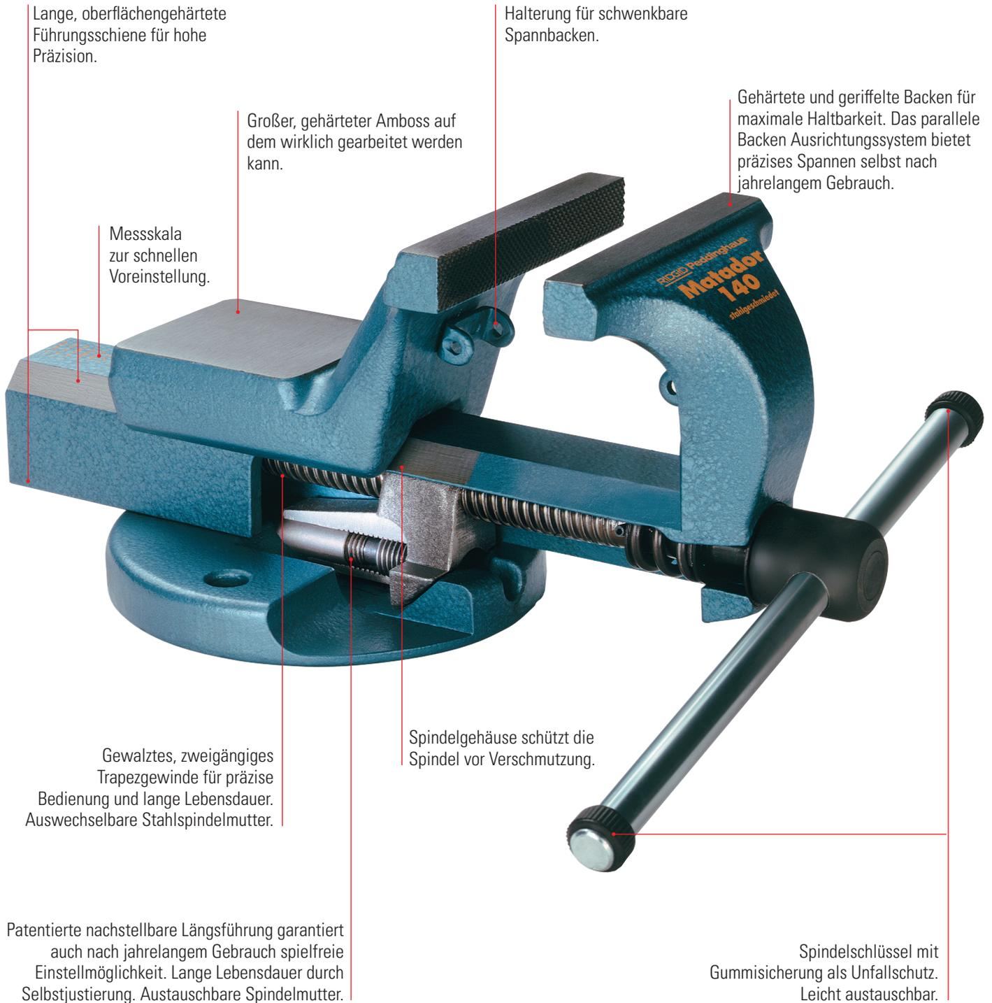
Lange, oberflächengehärtete Führungsschiene für hohe Präzision.
