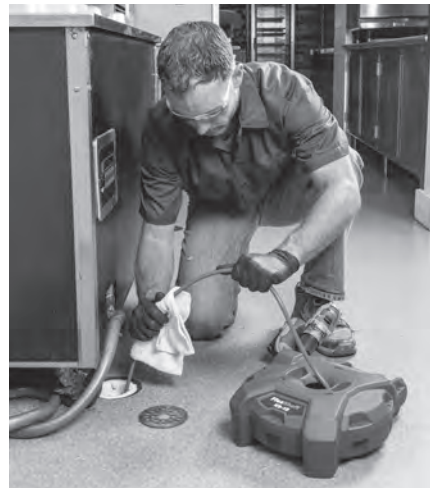
図 15 – ケーブルシースへの潤滑油の塗布
