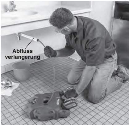
Abbildung 5 – Beispiel der Verlängerung der Abflussöffnung auf einen Abstand von maximal 3' zum Spiralaustritt der Maschine
