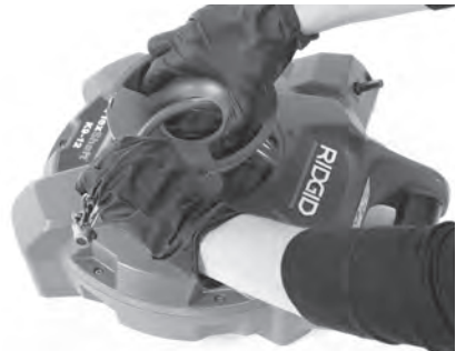
Abbildung 7C - Durchführen der Spirale durch das Deckelloch
