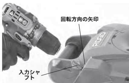
図4-入力シャフトにドリルを取り付ける
