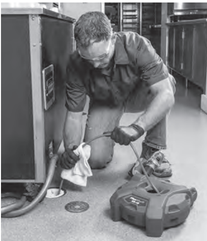
Abbildung 15 – Auftragen von Schmiermittel auf die Spiralenummantelung
