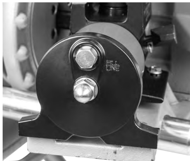
Figura 23 – Tapa del depósito
