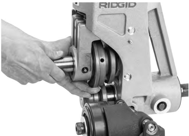
Figura 25 – Extracción del eje de retención y rodillo ranurador
