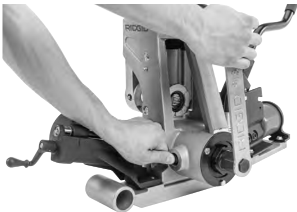
Figura 28 – Traba del husillo y aflojamiento del perno de tracción
