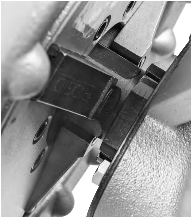
Figure 7B – Serrage du mandrin sur l'arbre de transmission
