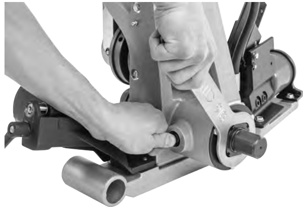
Figure 27 – Engagement de la broche de verrouillage et retrait de l'écrou de retenu de l'arbre de transmission
