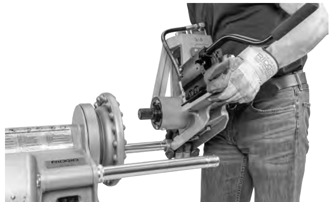
Figure 7A – Montage de la 918 sur système d'entraînement N° 300
