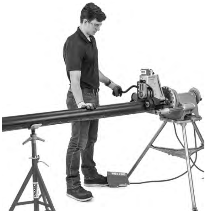
Figura 20 – Aplicación de presión sobre el tubo, con el accionamiento motorizado en dirección FOR
