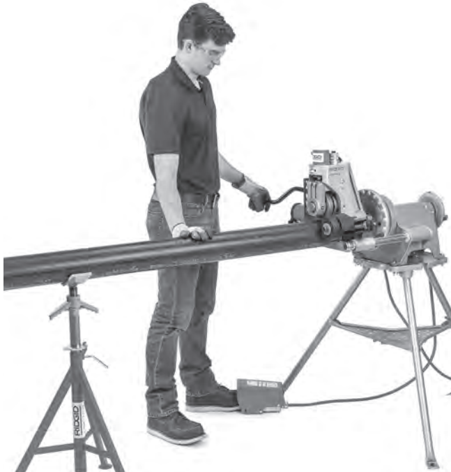
Abbildung 20 - Druckbeaufschlagung auf das Rohr mit elektrischem Antrieb in FOR-Richtung (Vorwärtsdrehung)
