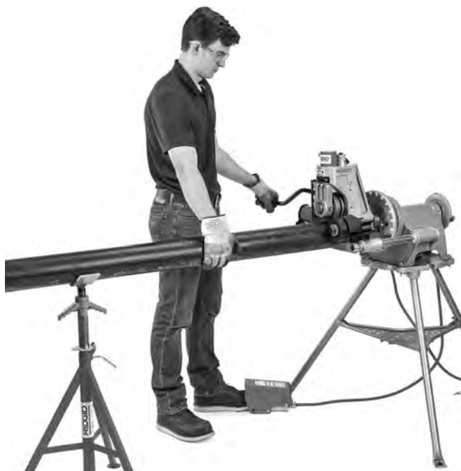
Figura 19 – Aplicación de presión sobre el tubo, con el accionamiento motorizado en dirección REV
