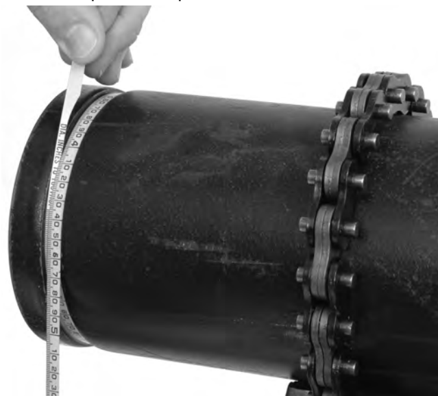
Figura 21 – Medición del diámetro en la ranura con la cinta de diámetros
