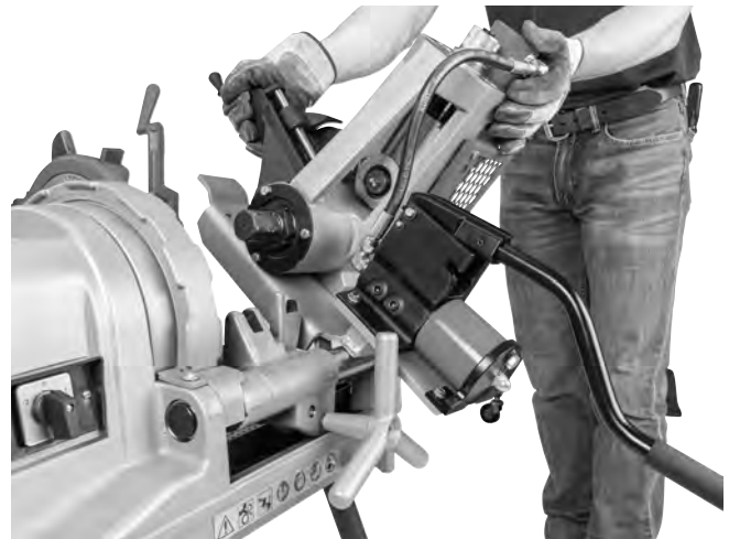
Figure 8B – Montage de la 918 sur fileteuse N° 1233
