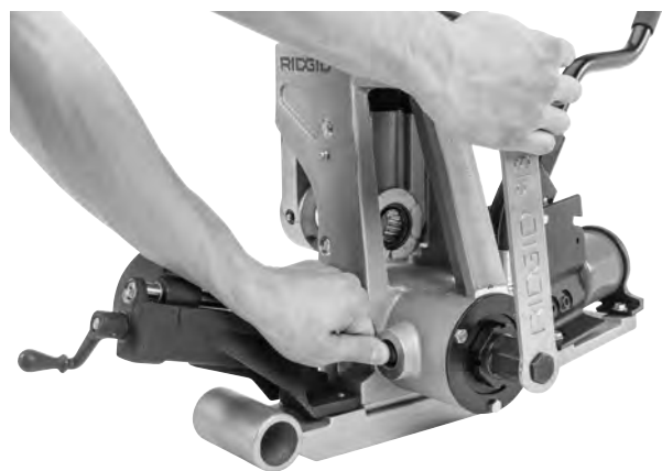
Figure 28 – Engagement de la broche de verrouillage et desserrage du boulon de retenu
