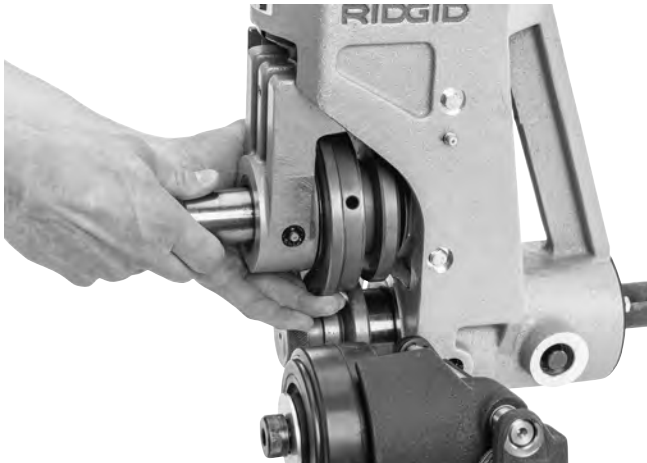
Figure 25 – Retrait de l'ensemble arbre/galet de rainurage
