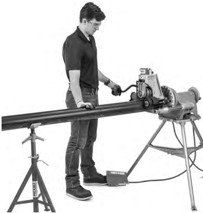
Figure 20 – Tuyau poussé légèrement en avant avec le système d'entraînement en position FOR
