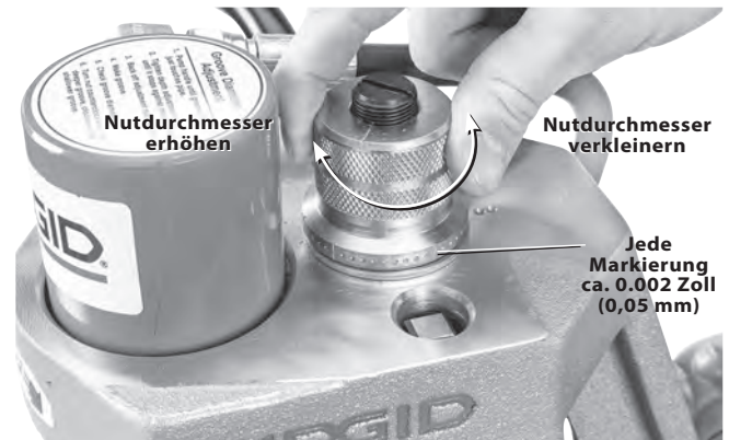
Abbildung 16 - Einstellung der Tiefeneinstellmutter
