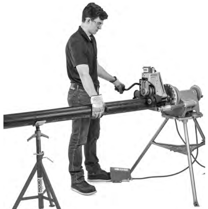
Figure 19 – Retenue du tuyau avec le système d'entraînement en position REV
