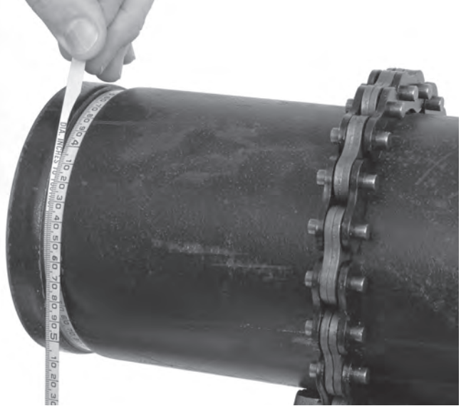
Abbildung 21 - Prüfen des Nutdurchmessers mit einem Durchmesserband
