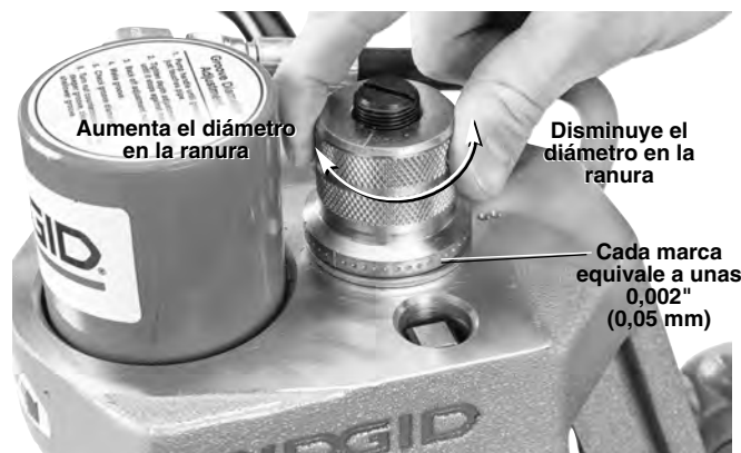
Figura 16 – Ajuste de la tuerca para fijar la profundidad
