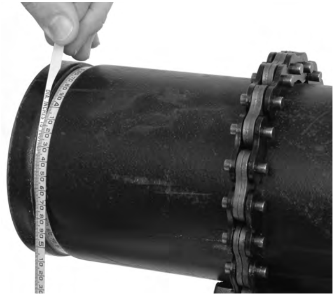
Figure 21 – Vérification du diamètre en fond de rainure à l'aide d'un ruban
