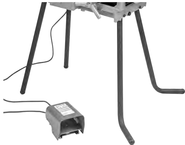
Figura 8 A – Patas tubulares (No. Cat. 56532) en posición correcta
