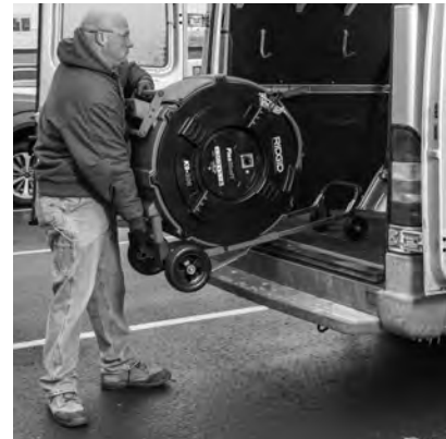
図 17 - ユニットを車両に持ち上げる
