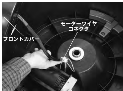
図 18 - 排水管清掃機ハウジング（カバーを外した状態）
