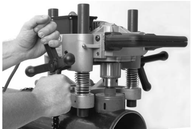
Figure 11 – Utilisation de la scie à cloche
