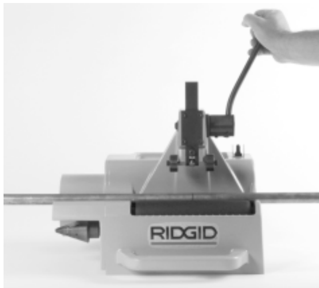
図 4 正しい操作位置と機械のセッティング
