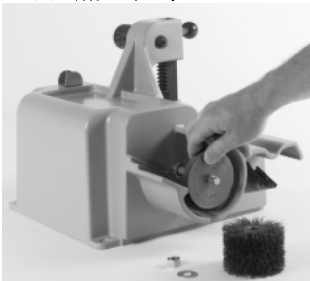
図 3 外面バリ取りディスクの取付け
