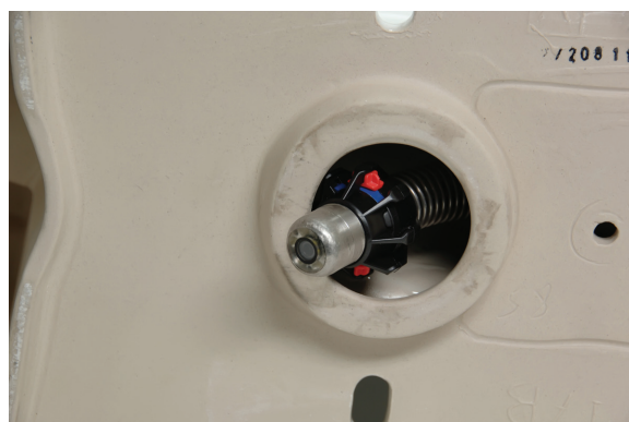
Afbeelding 17 – Camerakop met kogelgeleider in bocht
