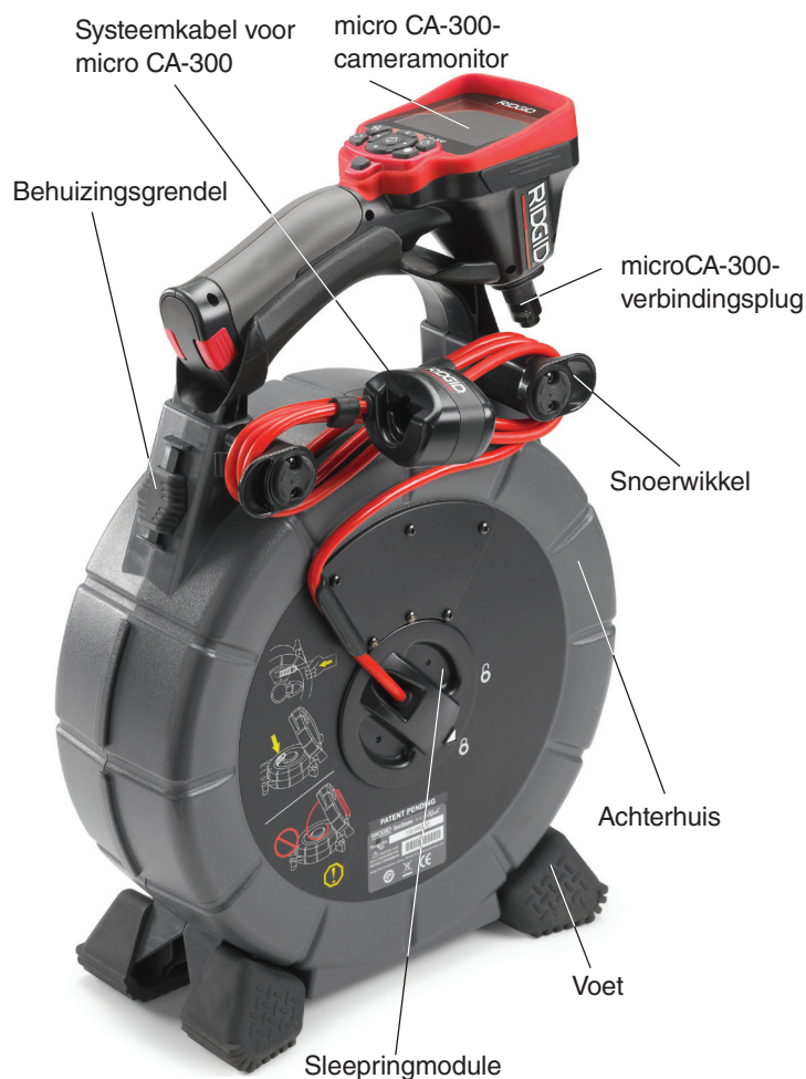
Afbeelding 3 – Achteraanzicht (micro CA-300-configuratie)
