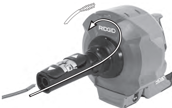
Figure 21 – Enroulage du câble sans changement de tambour interne.
