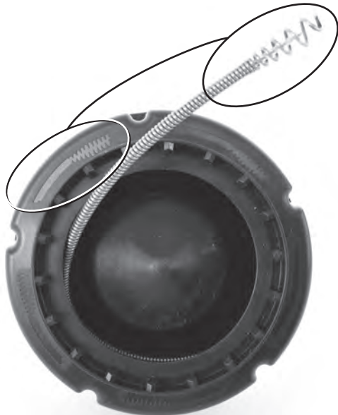
Abbildung 20 – Beim Einlegen der Spirale in eine Innentrommel die Spirale im Uhrzeigersinn aufwickeln
