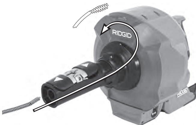
Figura 21 – Cargar el cable sin reemplazar el tambor interno
