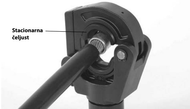
Slika 3 - Poravnanje priključaka u kalupu
