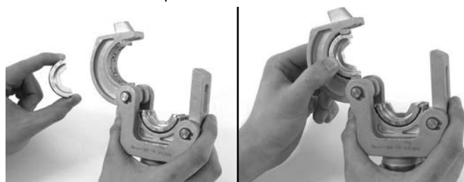
Figura 2 – Montarea matrițelor în capul de sertizare
