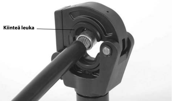
Kuva 3 – Liittimen kohdistaminen leukoihin
