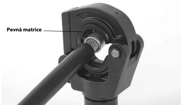
Obrázek 3 – Vyrovnaní konektoru v matricích
