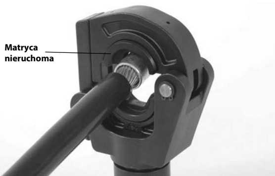
Rysunek 3 - Układanie złącza w matrycach
