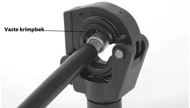
Figuur 3 – De connector uitlijnen in de bekken
