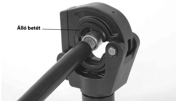
3. ábra – A csatlakozó elhelyezése a betétekben
