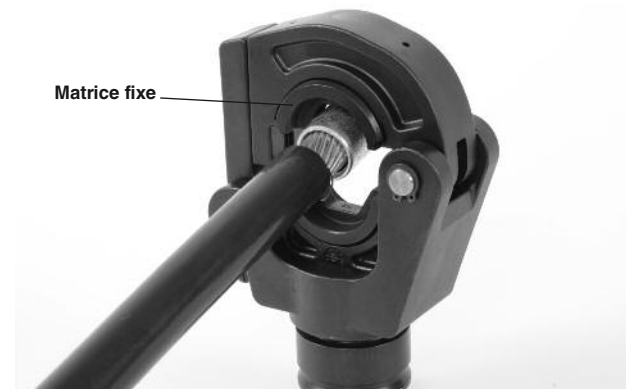
Figure 3 – Alignement du manchon dans les matrices
