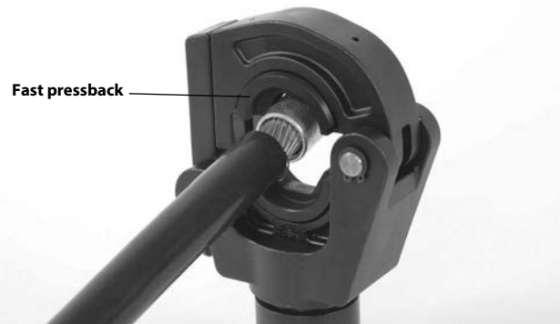
Figur 3 – Rikta in kontakten i pressbackarna
