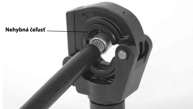
Obrázok 3 – Zarovnanie konektora v čelustiach
