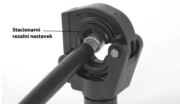
Slika 3 – Poravnavanje konektorja v rezalne nastavke
