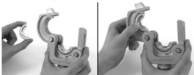
Slika 2 – Postavljanje čeljusti u glavu za krimpovanje
