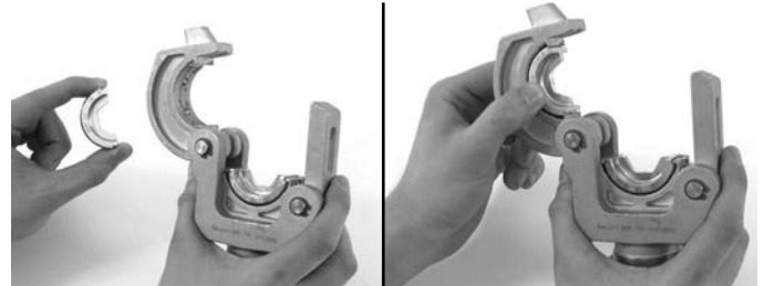
Εικόνα 2 – Τοποθέτηση μητρών στην κεφαλή σύσφιξης
