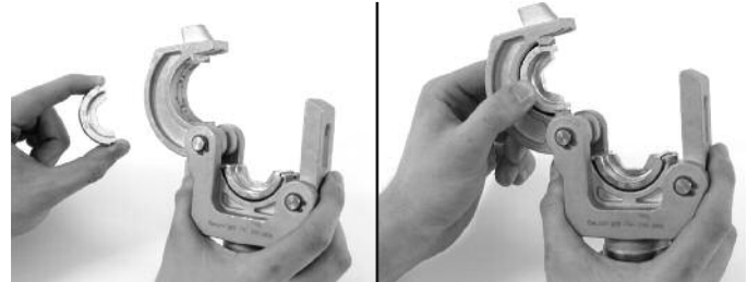
Figura 2 – Colocación de las terrajas en el cabezal engarzador
