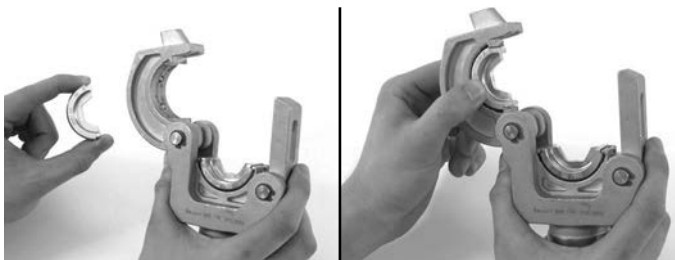
Abbildung 2 - Einsetzen der Backen in den Crimp-Kopf.
