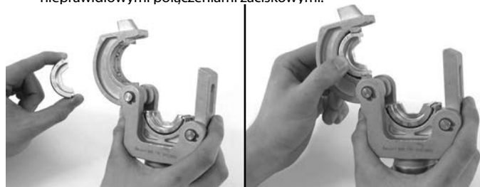
Rysunek 2 – Zakładanie matryc w głowicy
