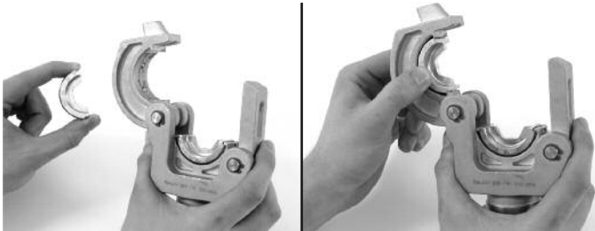
Figure 2 – Montage des matrices sur la tête de sertissage
