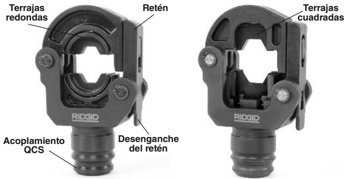
Figura 1 – Cabezal engarzador redondo (versiones intercambiables) Cabezal engarzador cuadrado
