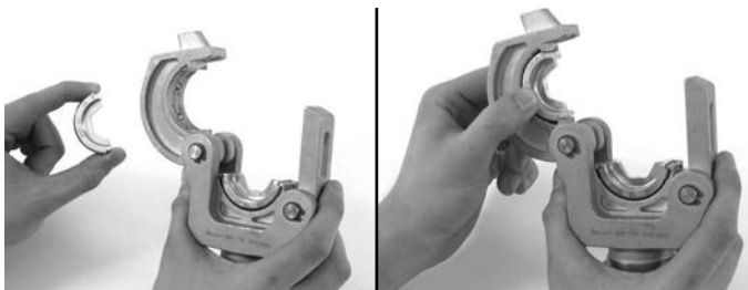
Slika 2 – Vgradnja rezalnih nastavkov v glavo za stiskanje
