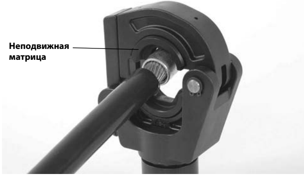
Рис. 3 – Выравнивание соединителя в матрицах
