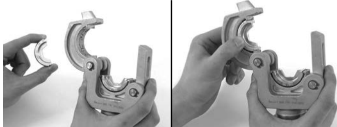
Figura 2 – Installazione degli Stampi nella Testa di pressatura
