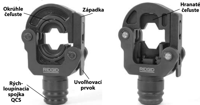
Obrázok 1 – Okrúhla krimpovacia hlava Hranatá krimpovacia hlava (Výmenné verzie)
