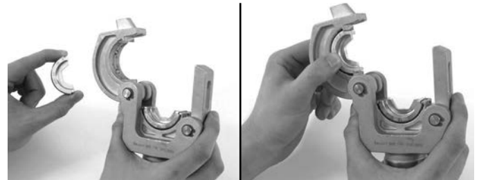
Figuur 2 – Bekken aanbrengen in de krimpkop
