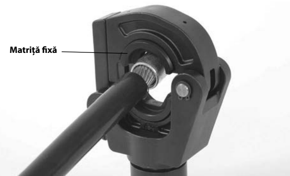
Figura 3 – Alinierea conectorului în matrițe
