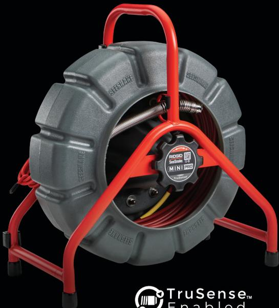
El SeeSnake® Mini Pro™ de RIDGID® dotado con autonivelación digital y tecnología TruSense™, ofrece una imagen más estable del interior de la tubería, sin rotación mecánica. Su cabeza de cámara autonivelante de 25 mm puede pasar codos de 90°. El cable de empuje de 61 m es moderadamente rígido, y logra un buen equilibrio entre la rigidez y la capacidad de pasar codos. La ausencia de piezas móviles en la cabeza de cámara mejora enormemente la esperanza de vida útil de la misma.
