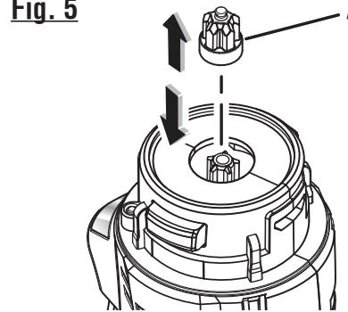
A - Drive gear cover (couvercle de l'engrenage d'entraînement, cubierta para los engranajes impulsores)
