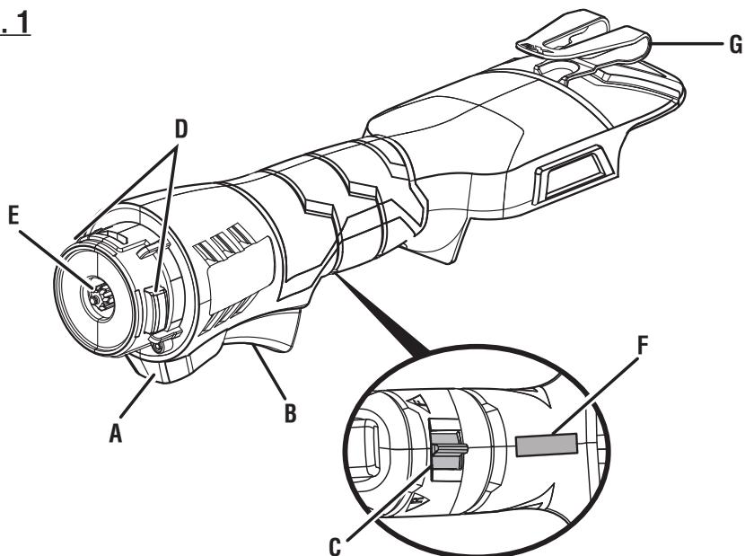
A - LED light (lampes à del, luz de trabajo de diodo luminiscente)
