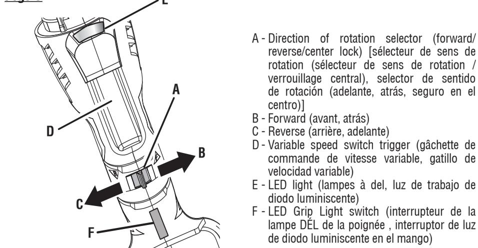
A - Direction of rotation selector (forward/reverse/center lock) [sélecteur de sens de rotation (sélecteur de sens de rotation / verrouillage central), selector de sentido de rotación (adelante, atrás, seguro en el centro)]
