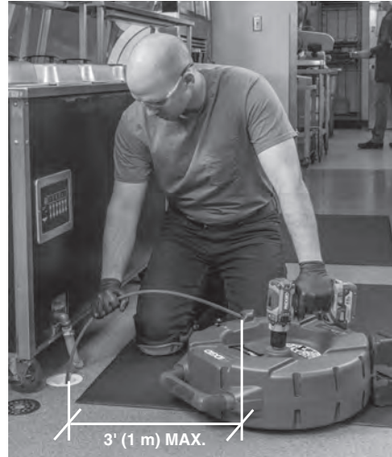
Figura 11 – Posición correcta para trabajar
