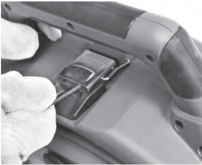
Abbildung 14 – Verschluss unter dem Tragegriff öffnen (mit Sechskantschlüssel)
