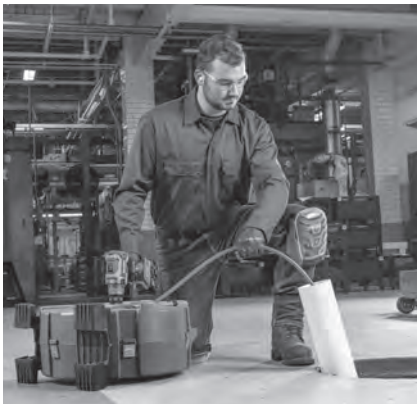
図5-機械のケーブル引出口から管入口までの距離を3'フィート以内に延長した例
