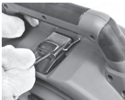
Figure 14 – Ouverture du loquet sous la poignée de transport à l'aide de la clé Allen
