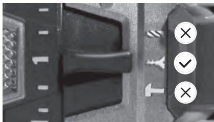
Figura 7 – Selección de la modalidad de funcionamiento correcta
