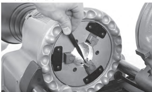
Figure 18 – Remplacement des mâchoires
