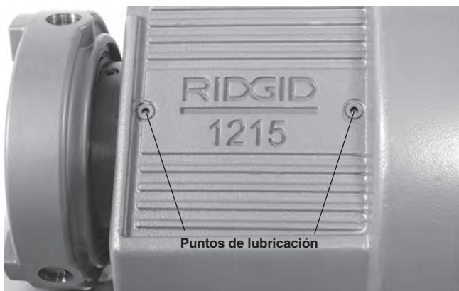
Figura 16 – Puntos de lubricación
