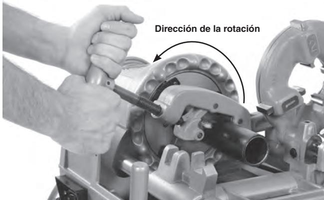
**Figura 11 – Corte de un tubo con el cortador No. 732**
