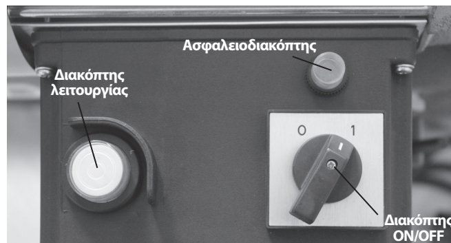
Εικόνα 9 – Χειριστήρια ηλεκτρικού κουρμαδόρου
