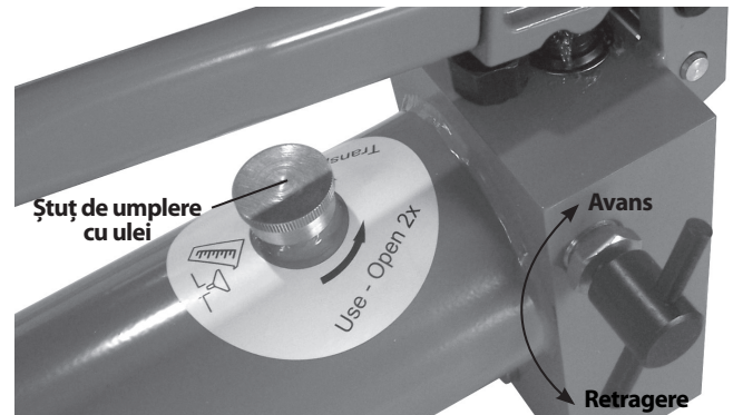
Figura 11 – Pozițiile butonului de eliberare (avans/retragere)
