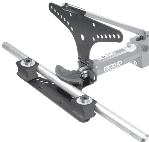
Figur 10 – Sette i røret
