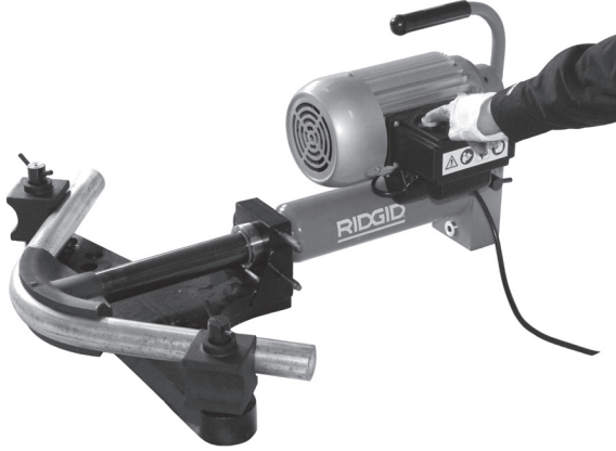
Şekil 14 – Açık Kanat Boru Bükmenin Çalıştırılması
