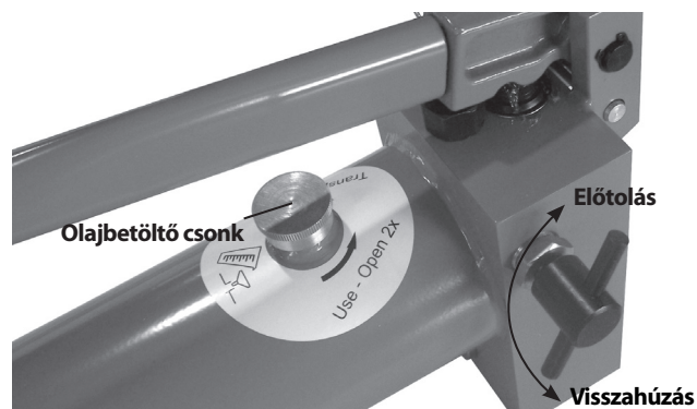
11. ábra – A kioldó forgatógomb pozíciói (Előtolás/Visszahúzás)
