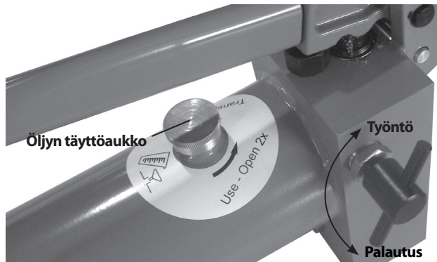
Kuva 11: Vapauttimen asennot (työntö/palautus)
