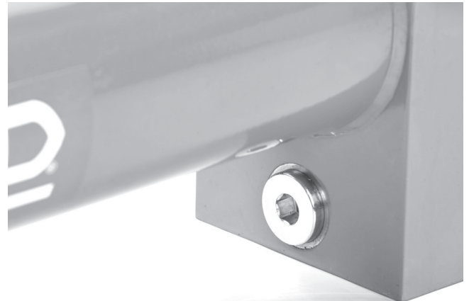
Şekil 19 – Hidrolik Yağ Tahliye Tıpası ve Filtre Erişimi
