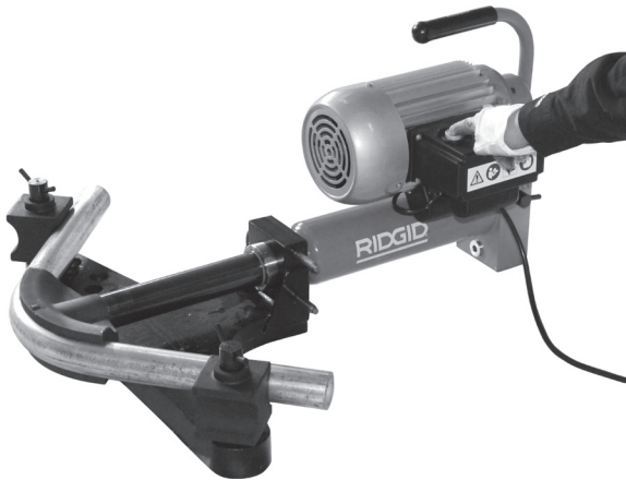
Рис.14 - Трубогиб с откидной верхней пластиной в действии
