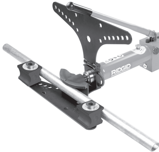
Figura 10 – Colocação do tubo
