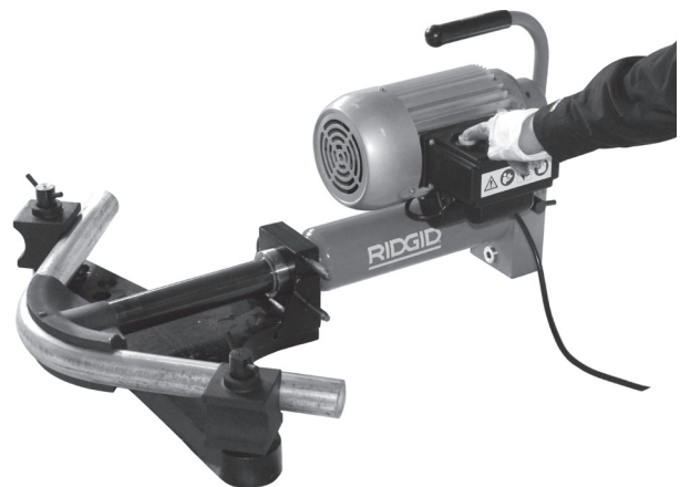
Figura 14 – Trabalhar com a Curvadora de Aleta Tipo Aberto
