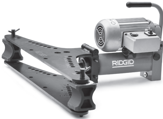
Kuva 2: Sähkökäyttöinen 2" ja 3" hydraulinen taivutin
