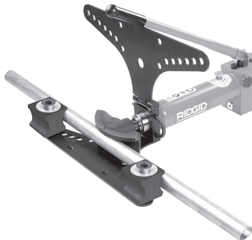
Figuur 10 – De pijp aanbrengen in de machine
