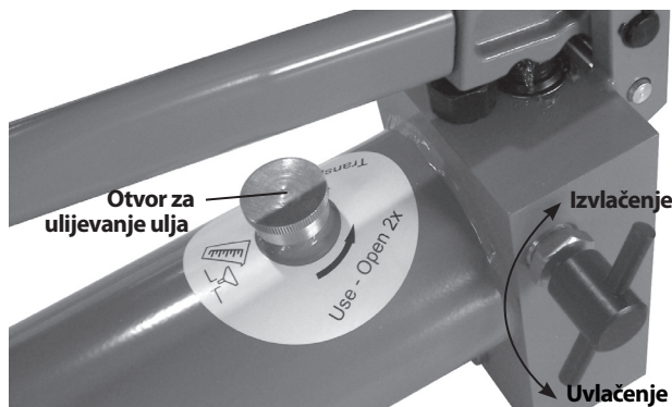
Slika 11 – Položaji otpusnog gumba (izvlačenje/uvlačenje)
