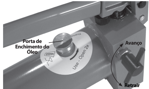
Figura 11 – Posições do Botão de Libertação (Avançar/Retrair)
