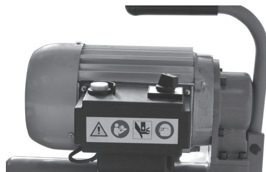
Figura 5B – Rótulo de aviso (Eléctrico)
