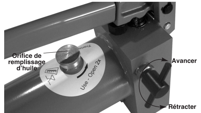
Figure 11 – Positions de la molette de verrouillage (Avancer/Rétracter)
