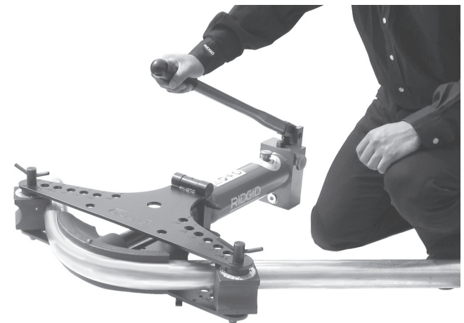
Kuva 13: Manuaalisen taivuttimen käyttö
