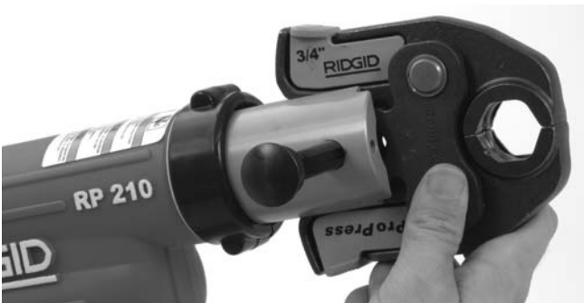
Figure 5 – Introduction de l'accessoire dans l'appareil
