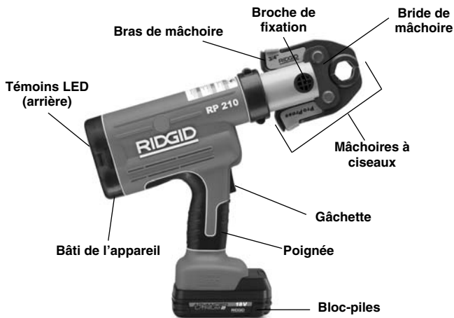
Figure 1 – Sertisseuse RP 210 avec mâchoires série Compact
