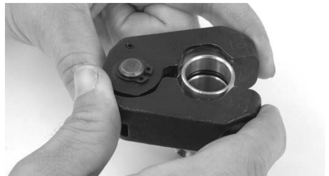
Figure 9 – Positionnement de la bague de sertissage sur le raccord
