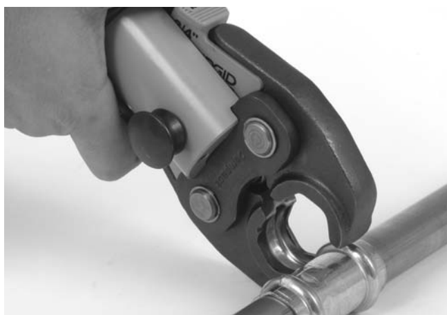
Figura 6 – Apertura de las mordazas tipo tijeras
