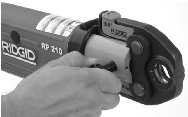
Figure 4 – Broche de fixation des accessoires en position complètement ouverte
