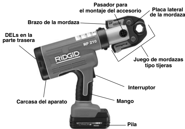
Figura 1 – Selladora RP 210-B (a pila) y juego de mordazas serie Compact
