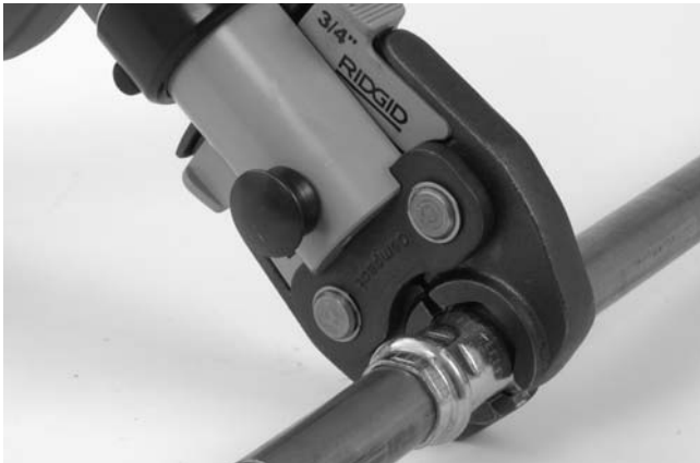
Figure 7 – Positionnement des mâchoires à ciseaux sur le raccord
