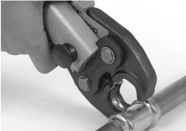
Figure 6 – Ouverture des mâchoires à ciseaux
