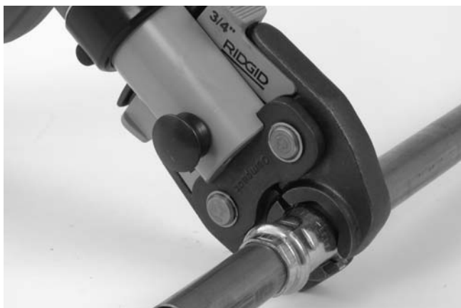
Figura 7 – Mordazas tipo tijeras rodeando el acoplamiento
