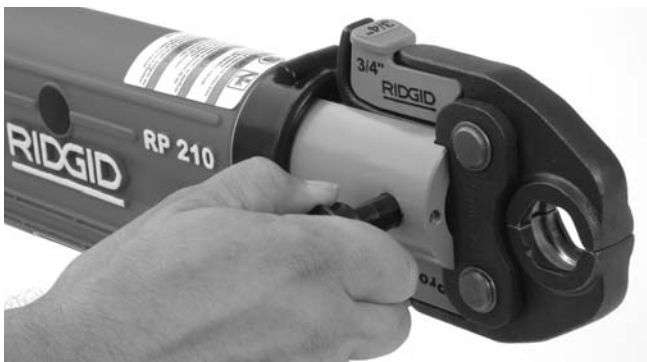
Figura 4 – Retire hasta atrás el pasador para el montaje del accesorio
