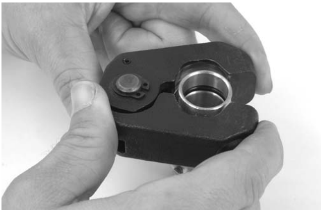
Figura 9 – Montaje del aro sellador sobre el acoplamiento
