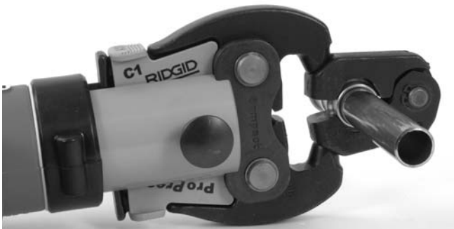
Figura 10 – Montaje del accionador en el aro sellador
