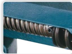
**8** Cage de protection de la vis, protège de la poussière et d'autres corps étrangers.
