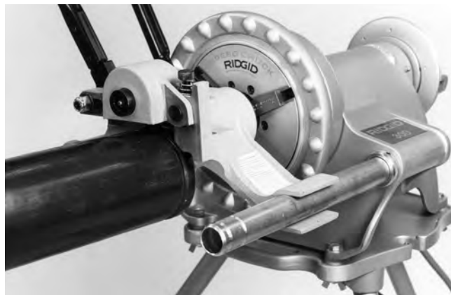
Figure 9 – Levier d'avancement en position relevée
