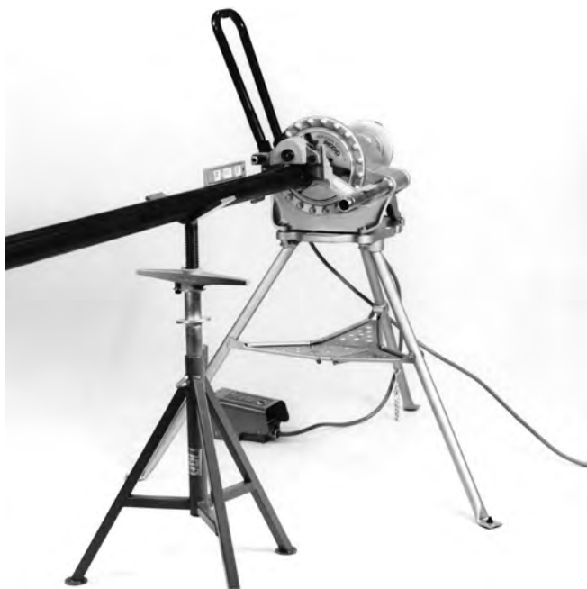
Figure 7 – Nivellement du tuyau.
