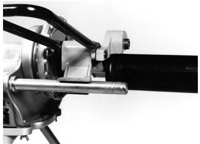
Figure 6 – Equerrage du tuyau et du porte-tubes
