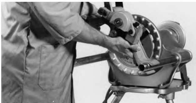
Figure 1 – Montage sur système d'entraînement n° 300
