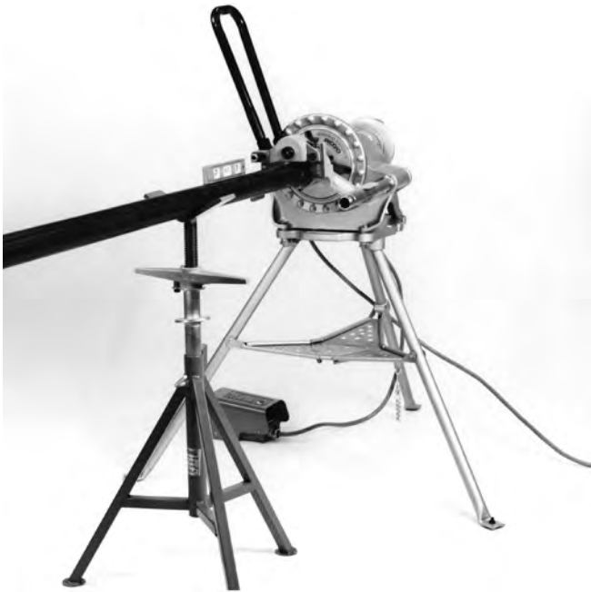
Figura 7 – Nivelación del tubo
