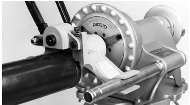
Figura 9 – Mango de alimentación en posición UP (arriba).
