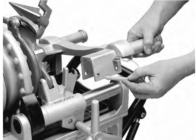
Figure 4 – Montage de l'adaptateur sur la machine à fileter 300 Compact
