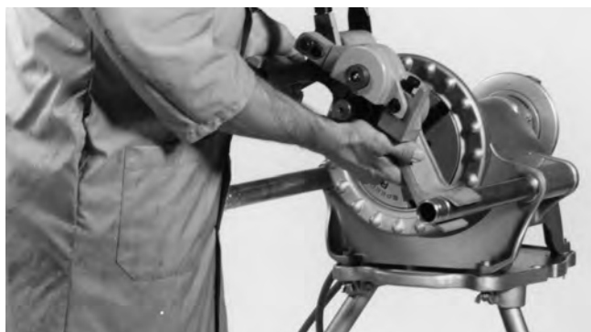
Figura 1 – Montaje sobre el Accionamiento motorizado No. 300
