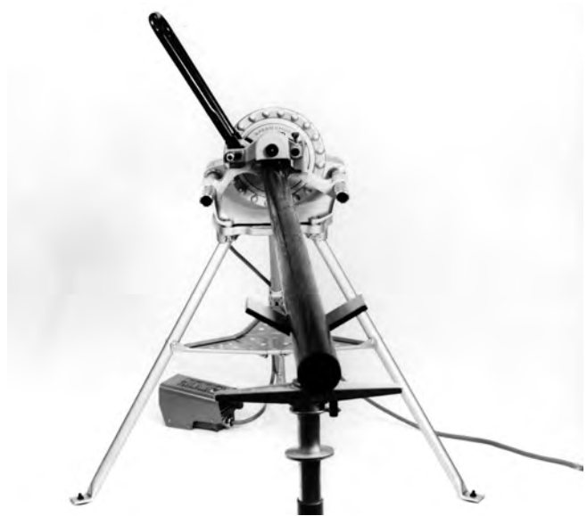
Figura 8B – Funcionamiento cuando la fuente de accionamiento marcha hacia delante (FOR)
