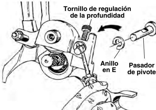
Figura 14 – Extraiga el anillo en E
