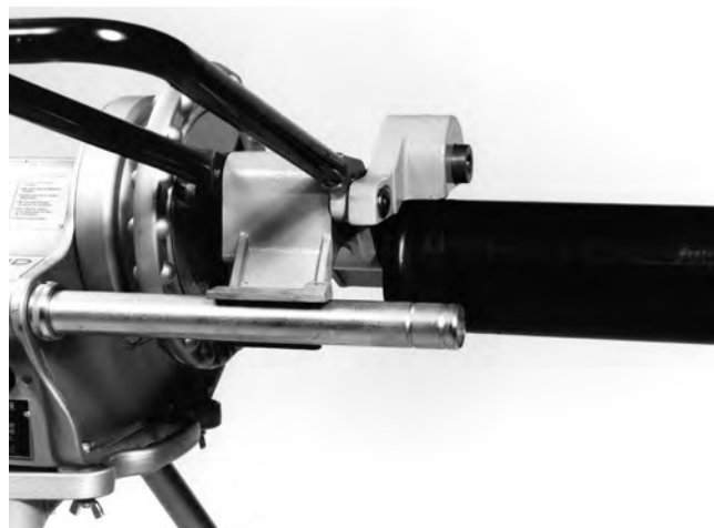
Figura 6 – Encadre el tubo y el portatubos con relación a la Ranuradora
