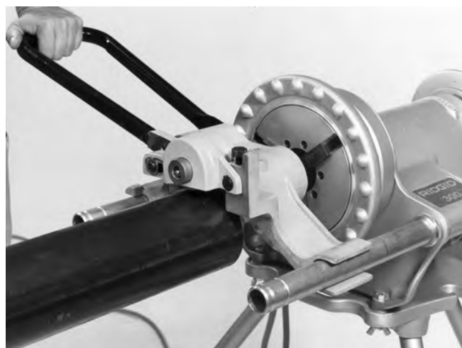
Figura 12 – Formación de una ranura a rodillo
