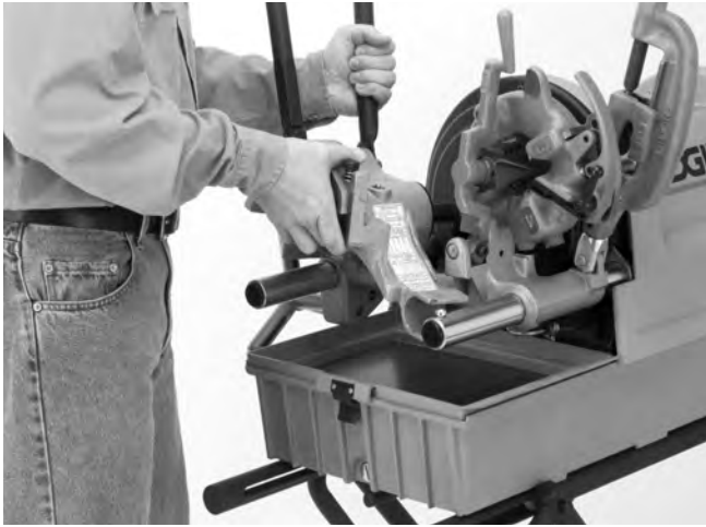
Figure 3 – Montage sur machine à fileter n° 1822-I (idem pour les machines à fileter 300 Compact et 535)
