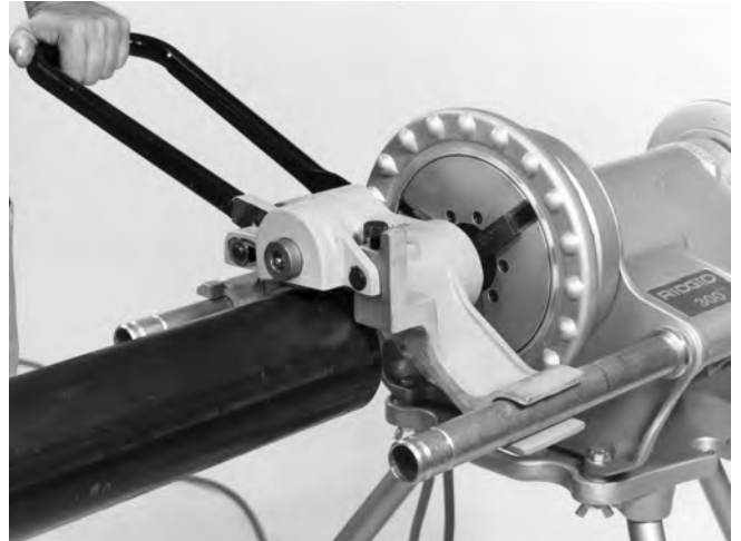
Figure 12 – Exécution du rainurages
