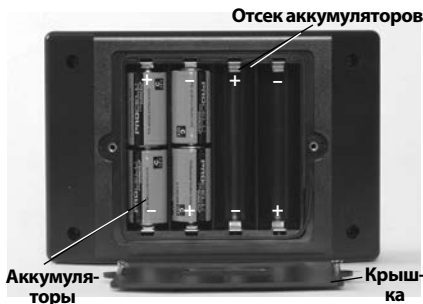
Рис. 6 – Замена аккумуляторов (передатчик)
