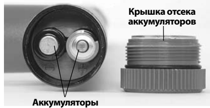
Рис. 7 – Замена аккумуляторов (приемник)
