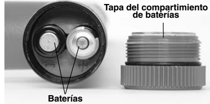
Figura 7 – Reemplazo de las baterías (receptor)
