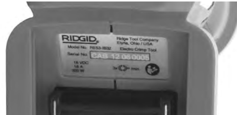
Şekil 4 – Makine Seri Numarası - İlk 4 rakam (daire içinde) üretim yılı ve ayını belirtir. (12 = yıl, 06 = ay).
