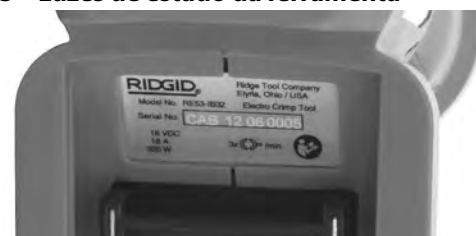
Figura 4 – Número de série da máquina - Os primeiros 4 dígitos (assinalados com um círculo) indicam o ano e o mês de fabrico. (12 = ano, 06 = mês).
