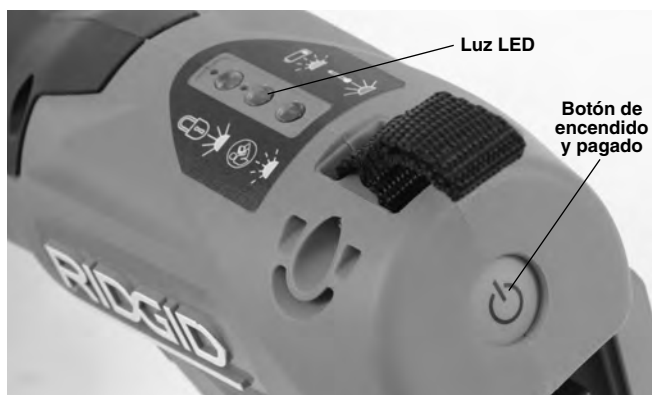
Figura 3 – Luces de estado de la máquina
