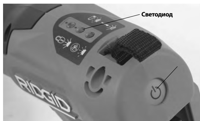
Рис. 3 – Индикаторы состояния инструмента
