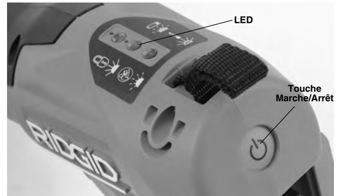
Figure 3 – Témoins d'état de fonctionnement
