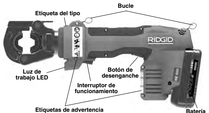
Figura 2 – Máquinas de la serie RE 600 con cabezal dedicado
