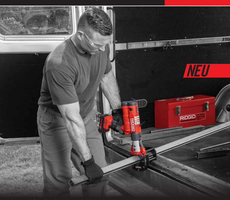
Der RIDGID® StrutSlayr ist ein neues Zubehör, dass das weltweit beliebte Presswerkzeug noch wertvoller macht. Der StrutSlayr lässt sich auf RIDGID® 32kN Standard Presswerkzeuge aufsetzen und schneidet binnen 5 Sekunden oder schneller, Montageschienen. Die Schienen werden gratfrei geschnitten, als wären Sie vorkonfektioniert geliefert worden.
