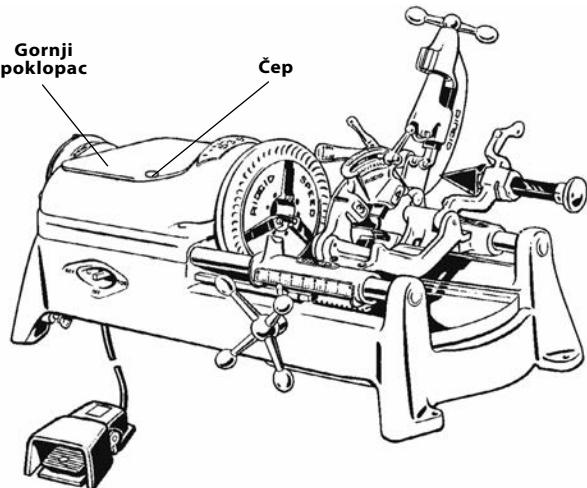
**Slika 31 – Nalivanje uljne pumpe, model A**
