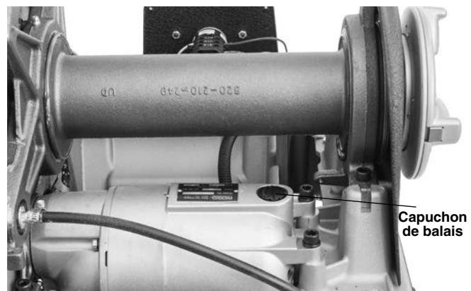
**Figure 34 – Retrait du capot et remplacement des balais**
