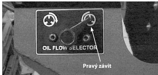
**Obrázok 24 – Volič ľavého alebo pravého prúdenia oleja**
