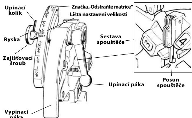
Obrázek 8 – Univerzální automaticky otevírací závitořezná hlava
