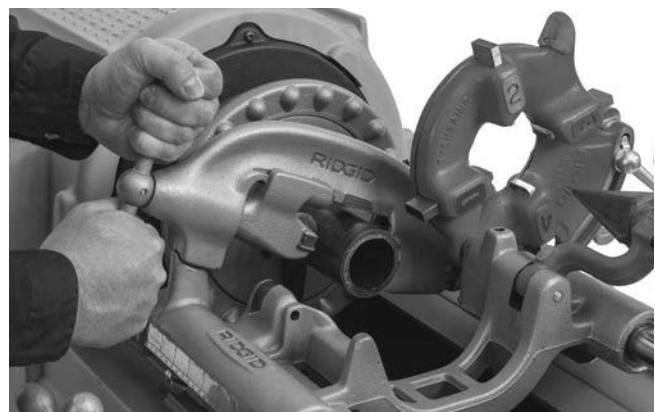
**Εικόνα 21 – Κοπή σωλήνα με κόφτη**
