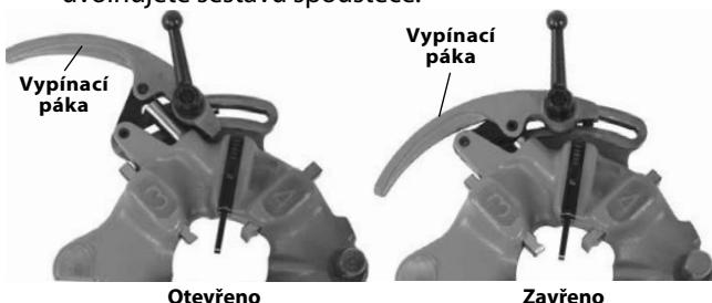
Obrázek 9 – Otevřená/zavřená poloha
