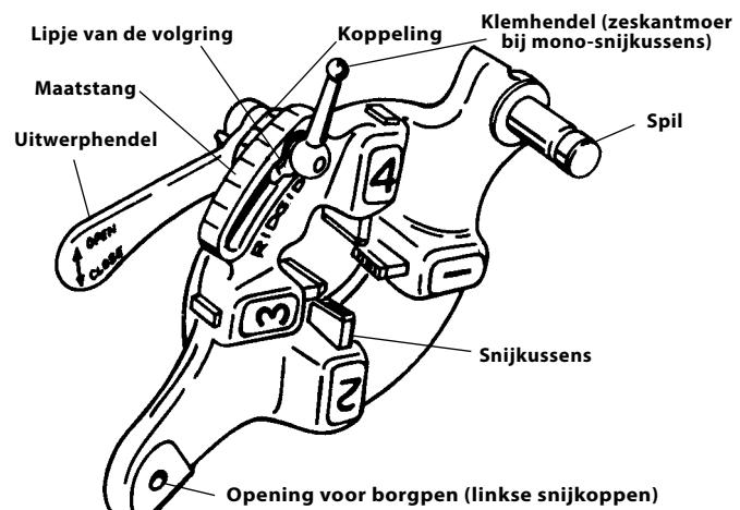
Figuur 4 – Snel openende draadsnijkop
