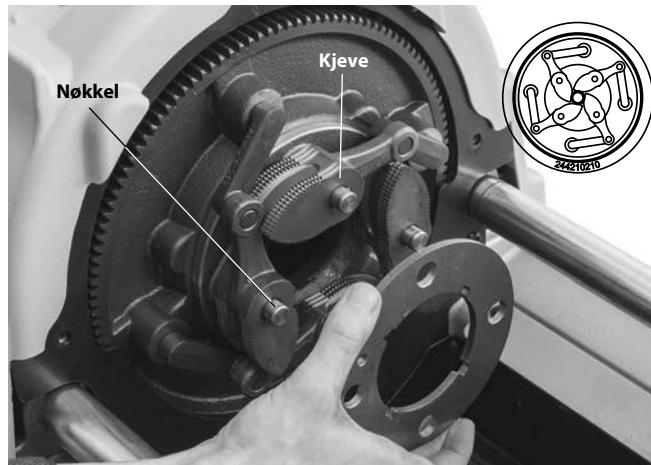
**Figur 32 – Skifte autochuck maskinkjever**
