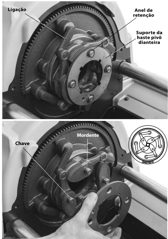
**Figura 32 – Substituir os mordentes da máquina de mandril automático**
