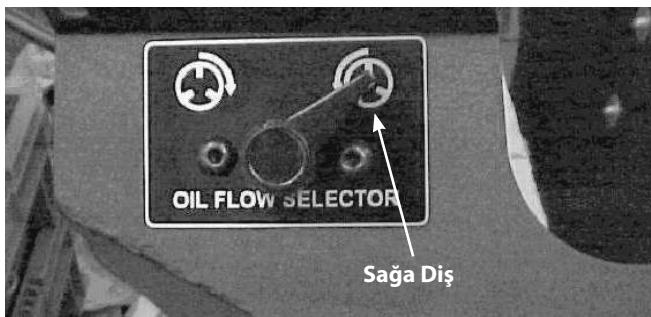
**Şekil 24 – SOL veya SAĞ Yağ Akış Seçici**
