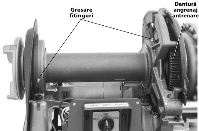
**Figura 29 – Puncte de lubrifiere**
