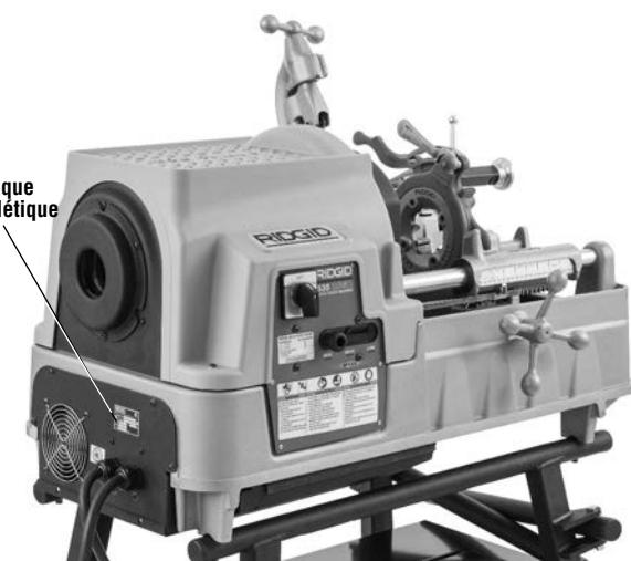
Figure 2B – Machine à fileter à mandrin automatique
