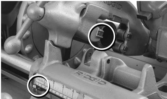
**Figura 20A – Lama a ruota della cesoia contro l'estremità del tubo. Impostare il puntatore sullo zero (0)**
