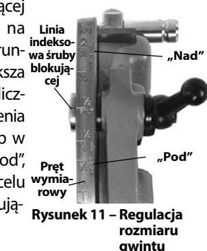
Rysunek 11 – Regulacja rozmiaru gwintu
