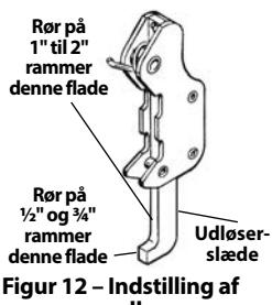
Figur 12 – Indstilling af udløser
