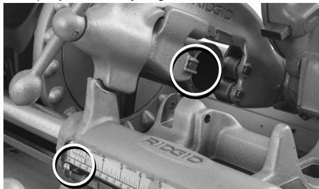
**Figura 20A - Lâmina do disco de corte contra a extremidade do tubo. Definir ponteiro para zero (0)**
