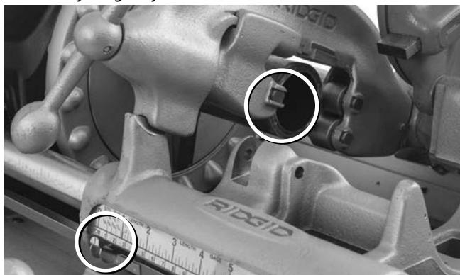
**Slika 20A - Oštirica kružnog noža naslonjena na kraj cijevi. Postavite pokazivač na nula (0)**
