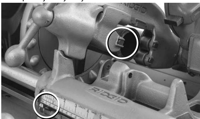
Slika 20A - rezilo rezalnega koluta na koncu cevi Nastavi kazalnik na nič (0)
