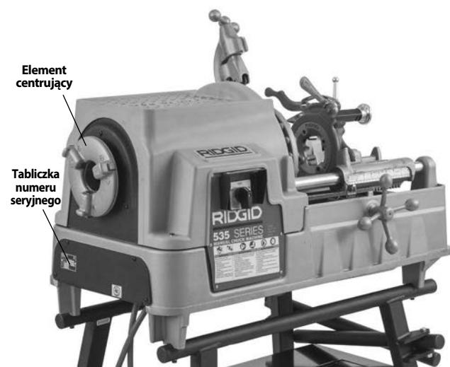
Rysunek 1B – Gwinciarka 535 z uchwytem ręcznym
