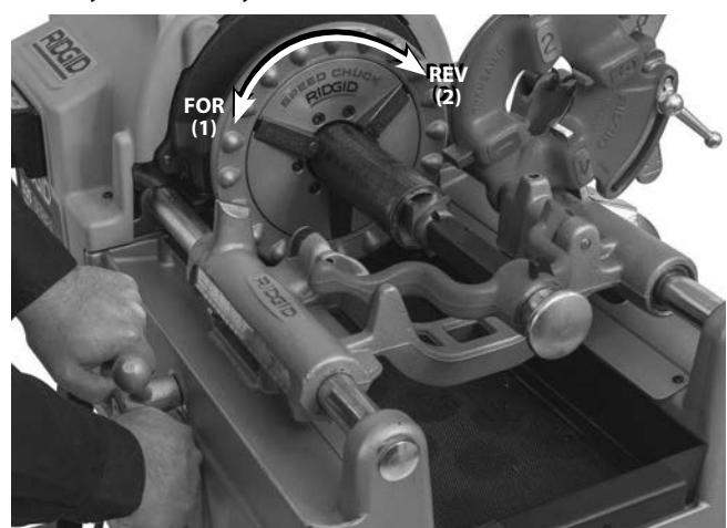
**Figur 22 – Opprømming av rør med brotsj, maskinrotasjon**
