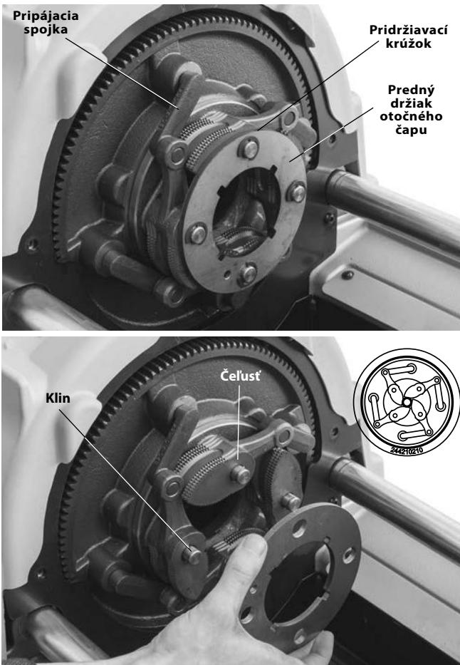
Obrázok 32 - Výmena čelustí stroja s automatickým skľučovadlom
