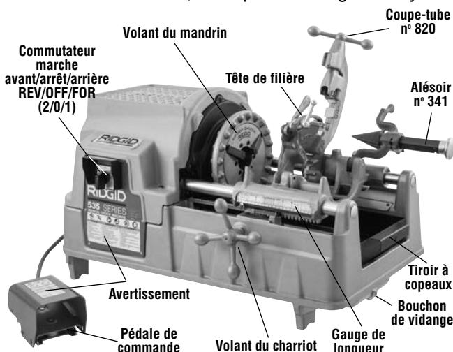
Figure 1A – Machine à fileter 535 à mandrin manuel
