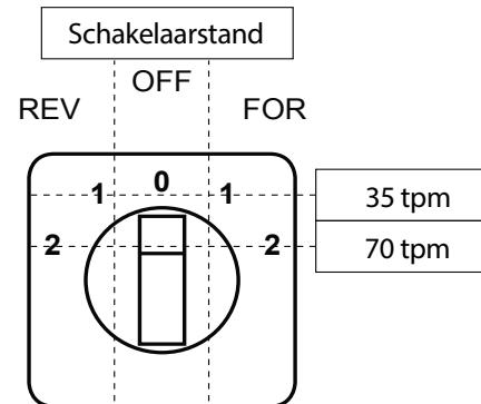
**Figuur 19 – 400 V 3-fasemachine: draairichting en snelheidsregeling**
