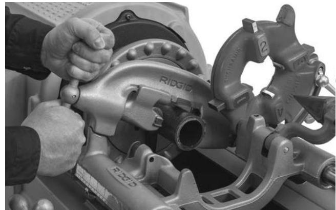
**Figur 21 – Kutt rør med kutter**
