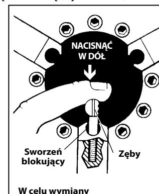
**Rysunek 33 – Wymiana wkładek szczek**
