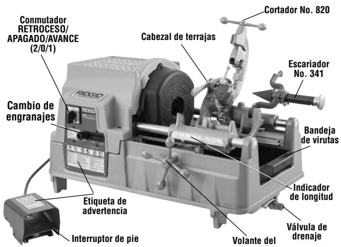
Figura 2A – Roscadora de mandril automático 535
