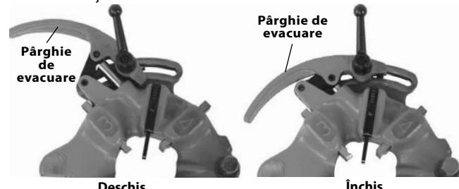
Figura 9 – Poziția deschis/inchis
