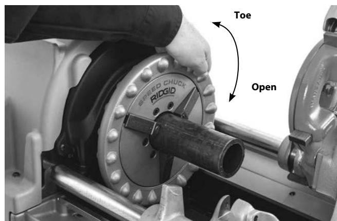
**Figuur 16 – Pijp in de klauwplaat vastzetten**
