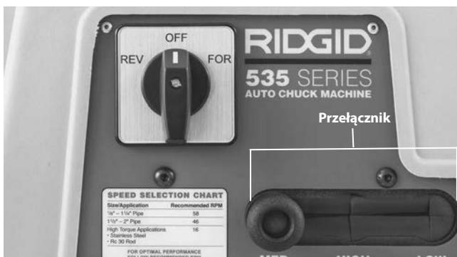
Rysunek 18 – Przełącznik gwiniarki 535
