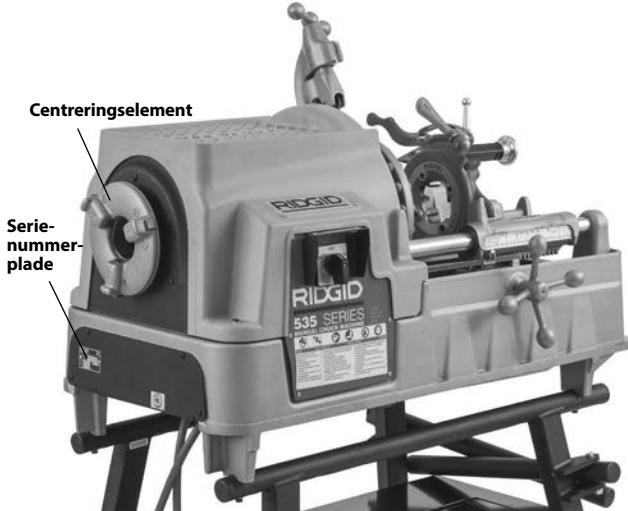
Figur 1B – 535 Gevindskærer maskine med manuel patron
