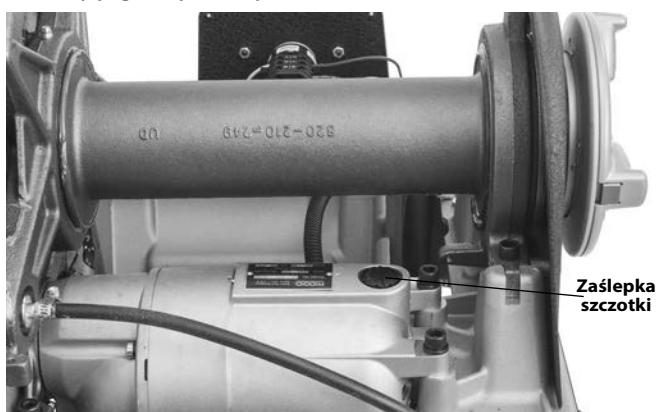
Rysunek 34 – Wymontowanie pokrywy silnika / wymiana szczotek
