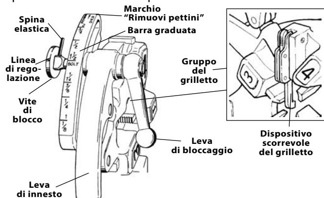
**Figura 8 – Testa portapettini ad apertura automatica universale**
