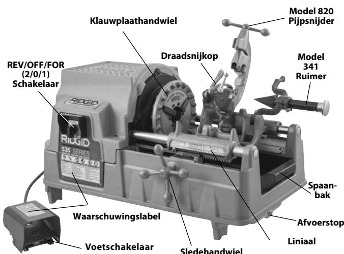
**Figuur 1A – Model 535 Draadsnijmachine met handbediende klauwplaat**
