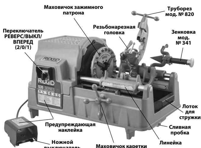
Рис. 1А – Резьбонарезной станок мод. 535
