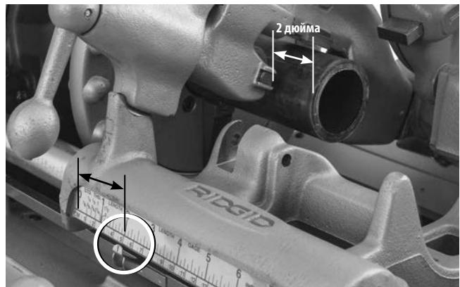
**Рис. 20В – Указатель линейки установлен на требуемую длину**
