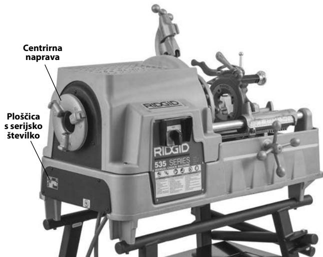
Slika 1B – 535 Naprava za rezanje navojev z ročno vpenjalno glavo
