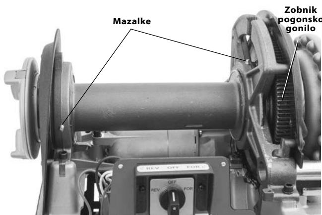
Slika 29 - Točke mazanja
