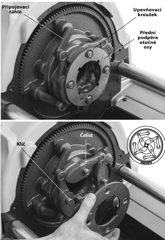
**Obrázek 32 – Výměna čelistí závitořezného nástroje s automatickým sklíčidlem**
