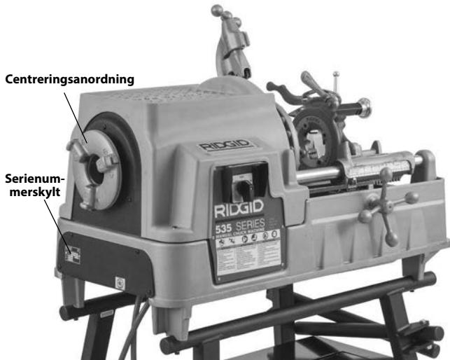
Figur 1B – 535 Manuell chuckgängningsmaskin
