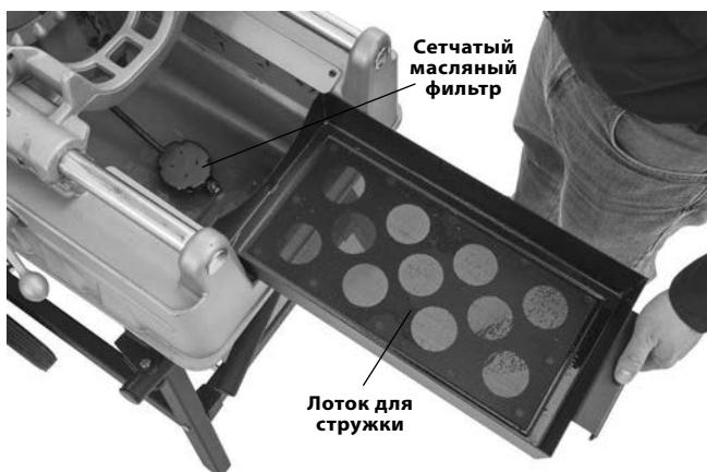
Рис. 30 – Снятие лотка для стружки
