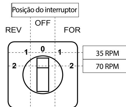
**Figura 19 - Controlo de direção e velocidade trifásico de 400 V**
