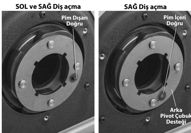
**Şekil 25B – Arka Pivot Çubuk Desteği - Pim Yerleşimi**
