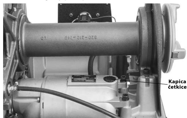
Slika 34 - Skidanje poklopca motora/zamjena četkica
