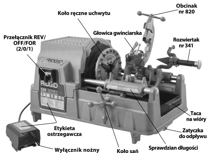
Rysunek 1A – Gwinciarka 535 z uchwytem ręcznym
