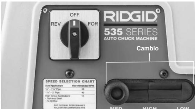
Figura 18 – Dispositivo de cambio 535
