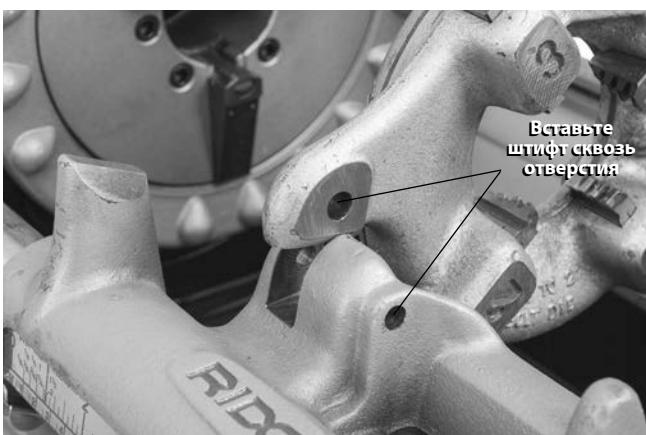
**Рис. 26 – Фиксация левой резьбонарезной головки на месте**
