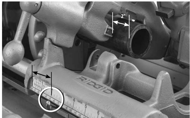
**Abbildung 20B – Zeiger der Längenmessskala auf ge-wünschter Länge**
