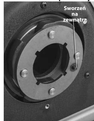
Rysunek 25B – Tylny wspornik obrotowy pręta – wkładanie sworzni
