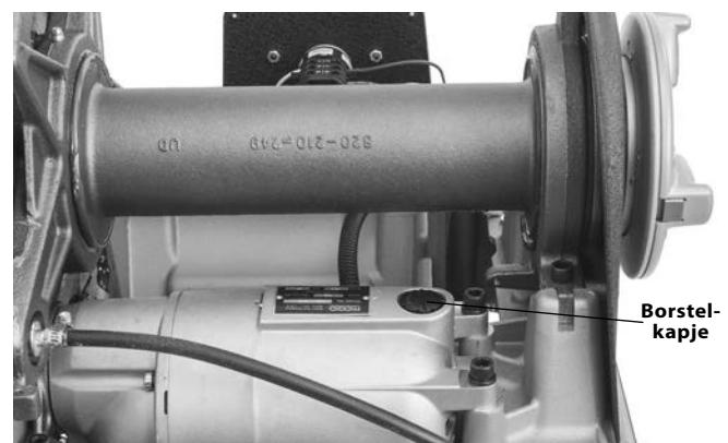
**Figuur 34 – Verwijderen van de machinekap / vervangen van de borstsels**
