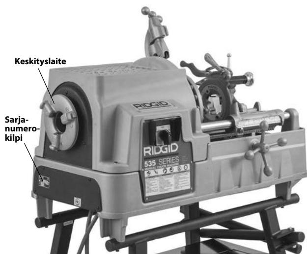
**Kuva 1B – 535 Manuaali-istukalla varustettu kierteityskone**
