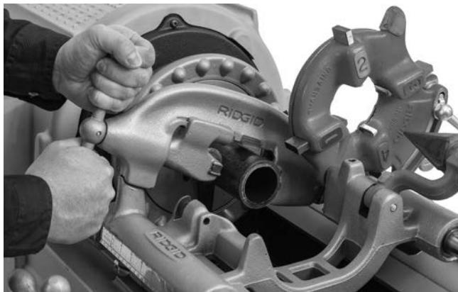
Figura 21 – Corte de un tubo con el cortador
