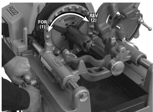
**Figur 22 – Fræsing af rør med fræser, maskinrotation**
