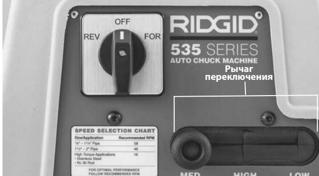
Рис. 18 – Рычаг переключения в мод. 535
