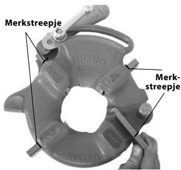
**Figuur 6 – Snikkussens aanbrengen**
