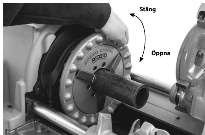
**Figur 16 – Chucka rör**
