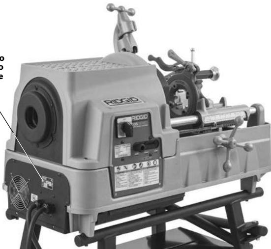
**Figura 2B - Máquina de roscar com mandril automático 535**
