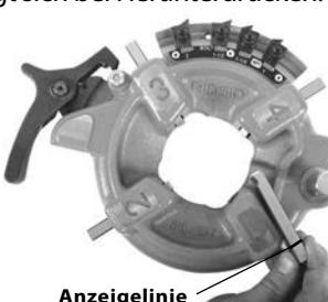
Abbildung 14 – Einsetzen der Schneidbacken
