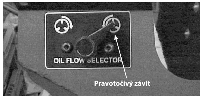
**Obrázek 24 – Levotočivý nebo pravotočivý volič průtoku oleje**
