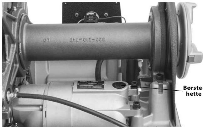
**Figur 34 – Fjerne motordeksel / skifte børster**
