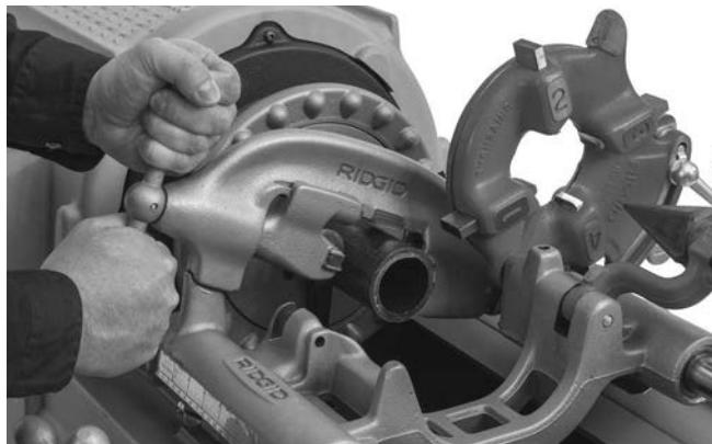
**Figuur 21 – Pijp snijden met de pijpsnijder**
