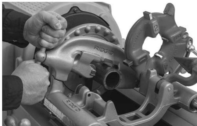
**Рис. 21 – Резка трубы с помощью трубореза**
