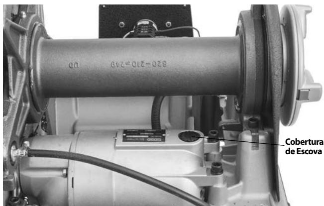
**Figura 34 – Retirar tampa do motor/substituir escovas**
