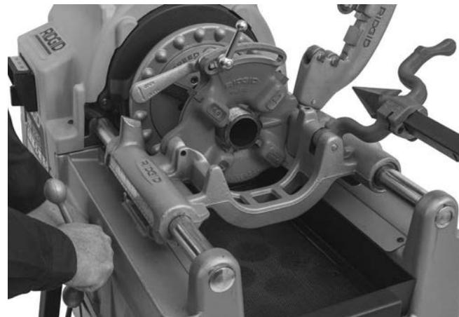
**Εικόνα 23 – Ελικοτόμηση σωλήνα**
