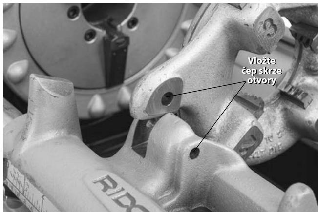
**Obrázek 26 – Zajištění levotočivé závitořezné hlavy na místě**
