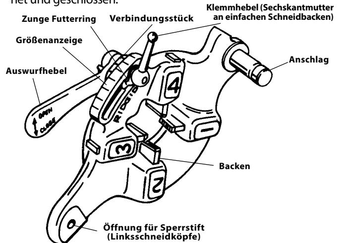
**Abbildung 4 – Schnellöffnender Schneidkopf**
