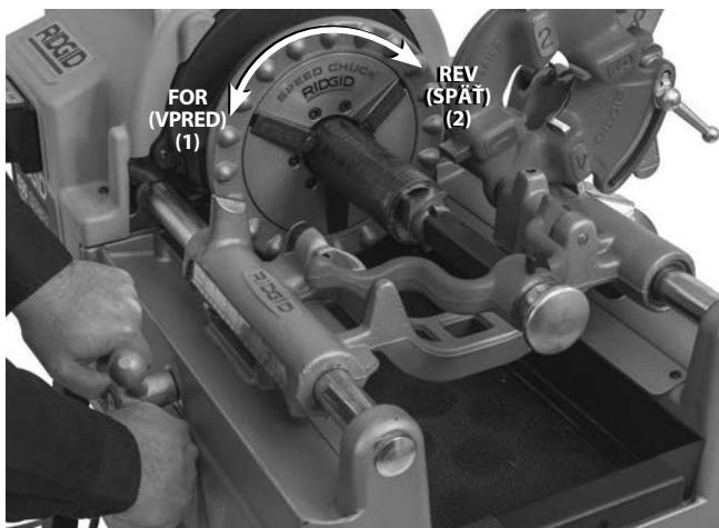
**Obrázok 22 – Odhrotovanie rúry pomocou odhrotovača, otáčanie stroja**
