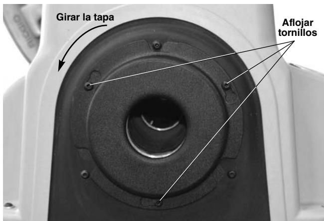
Figura 25 A – Extracción de la tapa trasera
