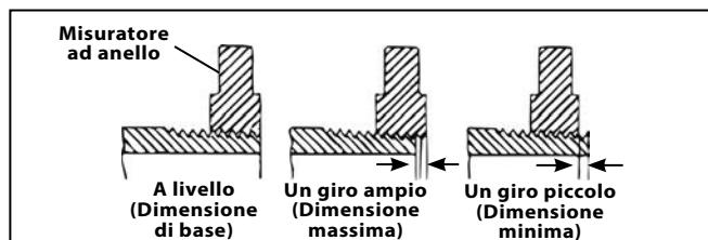
Figura 27 – Controllo della dimensione della filettatura
