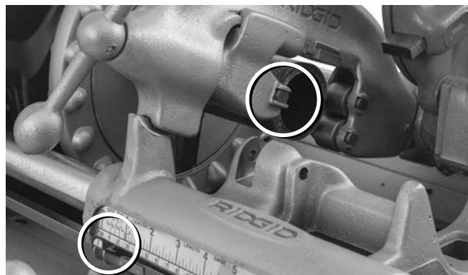
Figura 20A – Lama discului port-cuțit aplicată pe capătul țevii. Treceți cursorul la zero (0)
