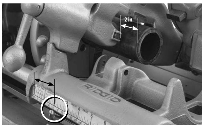
**Figuur 20B – Liniaalaanwijzer op de gewenste lengte**
