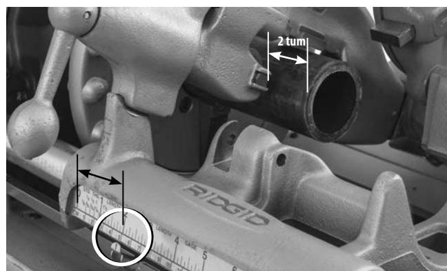
**Figur 20B – Längdmätarens visare på önskad längd**
