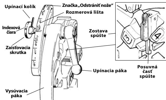
Obrázok 8 – Univerzálna samootváracia závitorezna hlava
