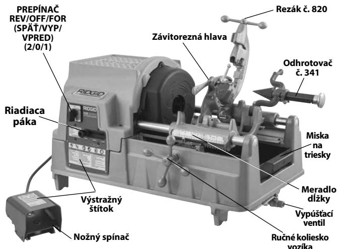
Obrázok 2A – Závitorez 535 s automatickým sklučovadlom
