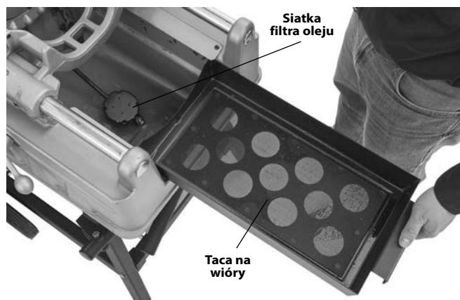
Rysunek 30 – Wysuwanie tacy na wióry
