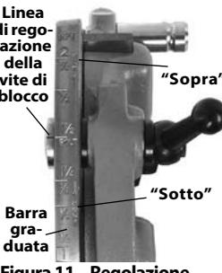
**Figura 11 – Regolazione della dimensione della filettatura**
