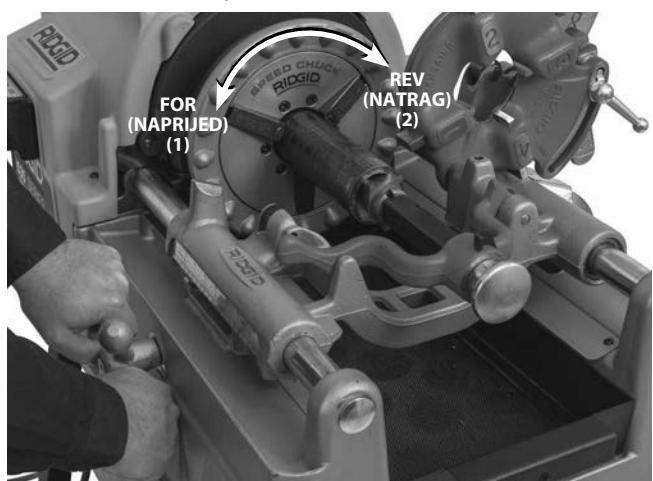
**Slika 22 - Proširivanje cijevi s razvrtačem, okretanje stroja**
