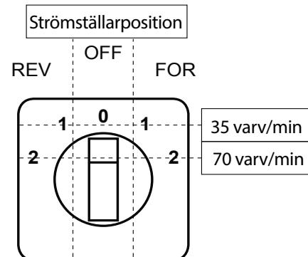
Figur 19 – 400 V 3-fas hastighets- och riktningsreglage
