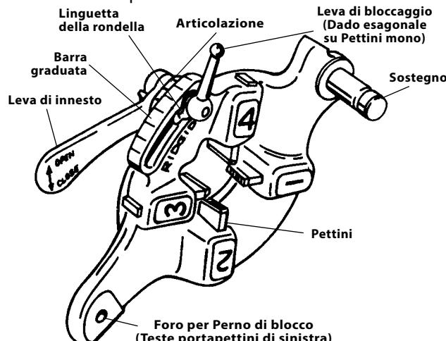
**Figura 4 – Testa portapettini ad apertura rapida**
