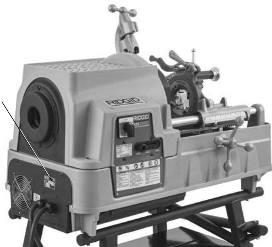
2B Ábra – 535 Automata tokmányos menetvágó gép
