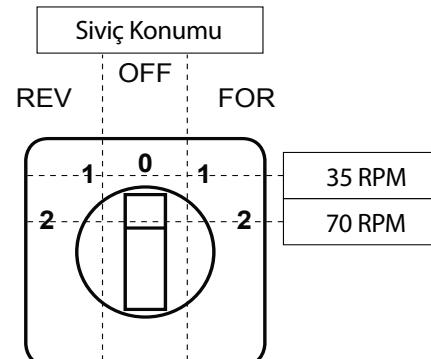
**Şekil 19 – 400 V 3 fazlı Hız ve Yön Kontrolü**
