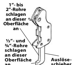
**Abbildung 12 – Einstellen der Auslöse-vorrichtung**
