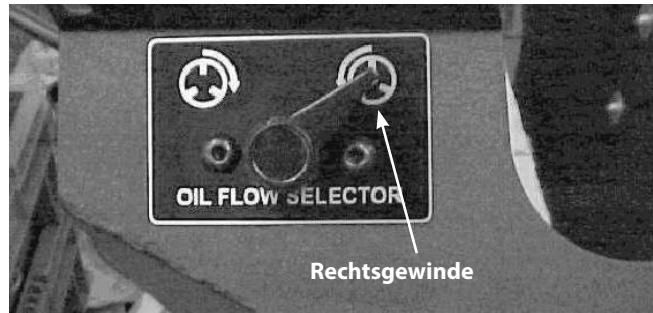
Abbildung 24 – Wähler Ölfluss nach links oder rechts
