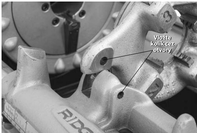
**Obrázok 26 – Upevnenie ľavotočivej závitoreznej hlavy na mieste**
