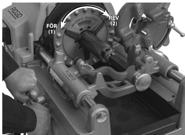
**Figur 22 – Fräsning av rör med fräs, maskinrotation**
