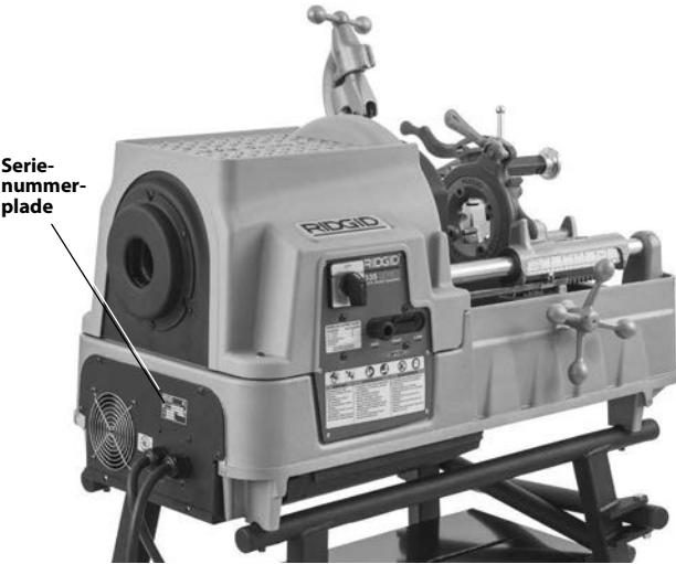
Figur 2B – 535 Gevindskærer maskine med automatisk patron
