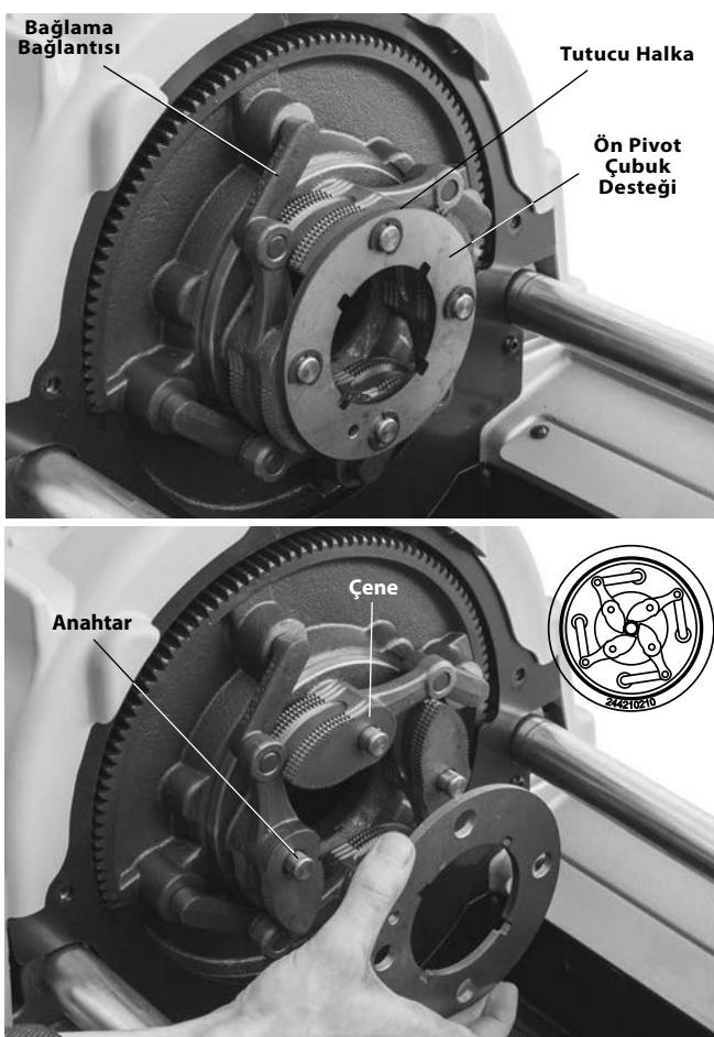
Şekil 32 – Otomatik Ayna Makine Çenelerinin Değiştirilmesi
