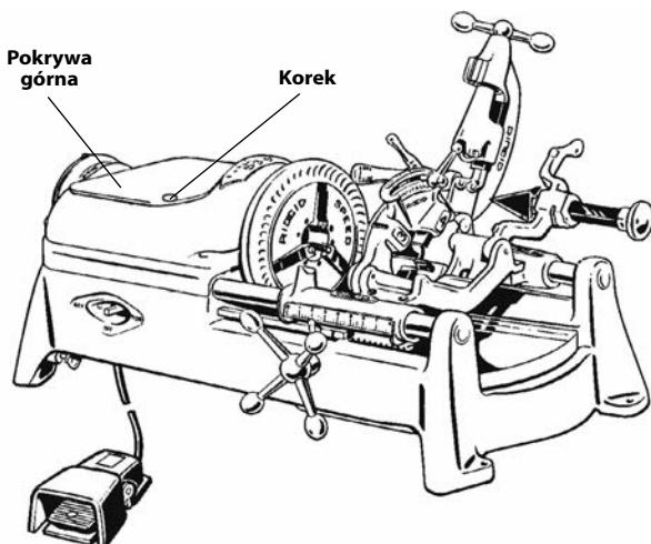
**Rysunek 31 – Zalewanie pompy oleju model A**
