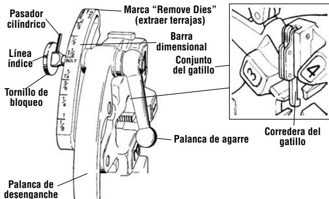
Figura 8 – Cabezal de terrajas universal, de autoapertura
