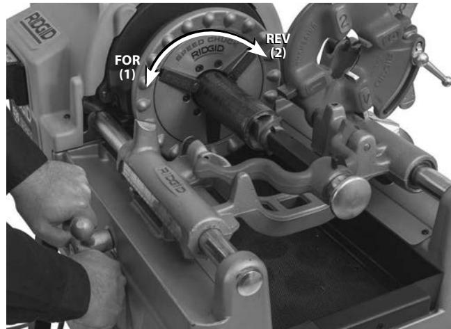
Rysunek 22 – Rozwiercanie rury rozwiertakiem, obroty maszyny
