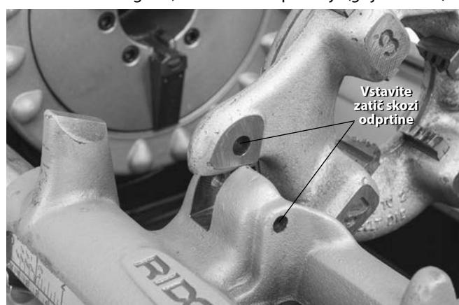
Slika 26 - Zadržanje LR navojnega rezalnika na mestu
