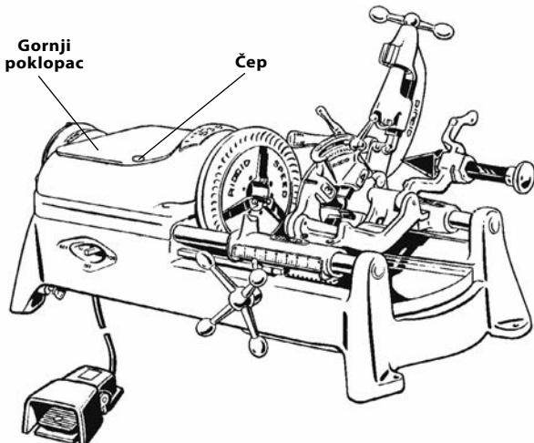
**Slika 31 - Podmazivanje crpke modela A**
