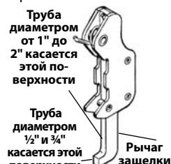
Рис. 12 – Установка защелки
