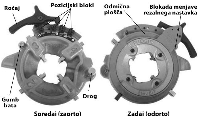
Slika 13 – Pol-avtomatski navojni rezalnik
