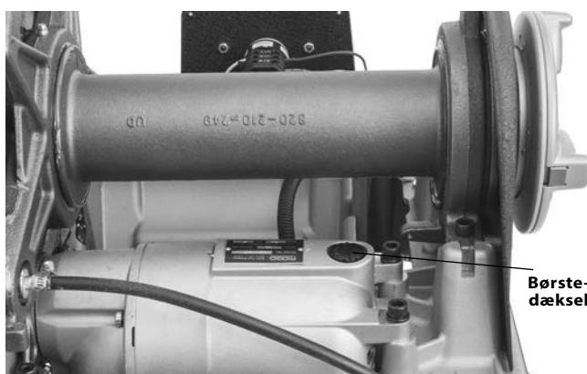
**Figur 34 – Afmontering af motordæksel/udskiftning af børster**
