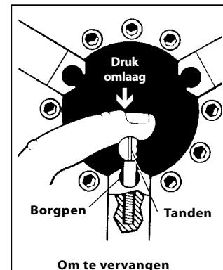
**Figuur 33 – Inzetstukken van de spanklauw vervangen**
