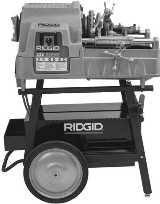
**Рис. 28 – Станок, подготовленный к транспортировке**
