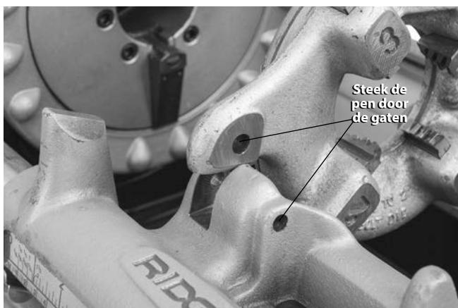
**Figuur 26 – Linkse draadsnijkop op zijn plaats houden**
