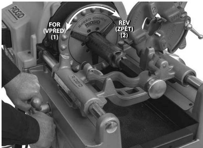
**Obrázek 22 – Odhrotování trubky pomocí odhrotovače, strojní rotace**
