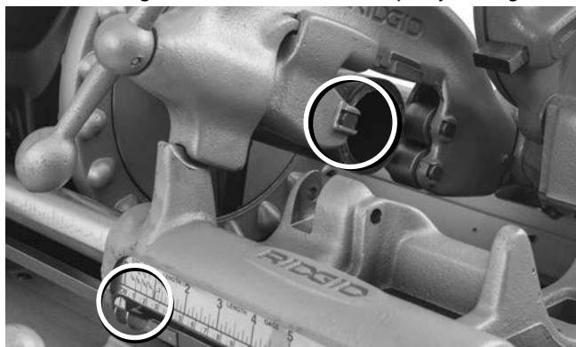
**Figur 20A – Kuttehjulblad mot enden av røret.
