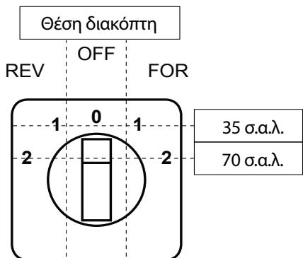
**Εικόνα 19 – Χειριστήριο στροφών και κατεύθυνσης 400 V
