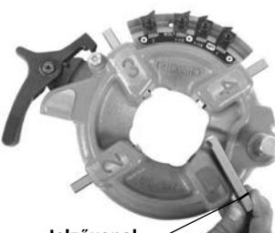
14. Ábra – Menetvágó szerszám behelyezése
