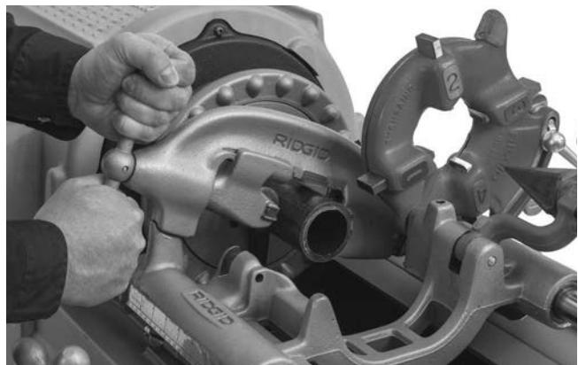
**Figur 21 – Tilskæring af rør med rørskærer**
