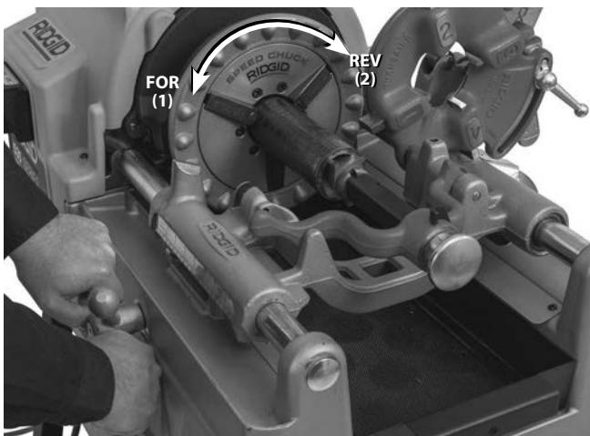
**Slika 22 – Razvrtanje cevi razvrtačem, rotacija mašine**
