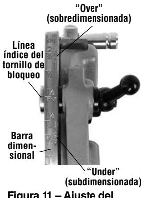
Figura 11 – Ajuste del tamaño de la rosca
