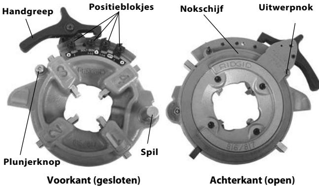
Figuur 13 – Semiautomatische draadsnijkop
