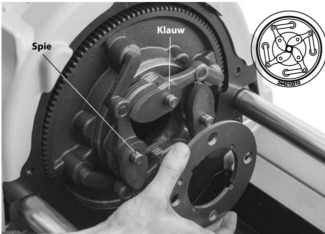
**Figuur 32 – Klauen vervangen bij machines met automatische klauwplaat**
