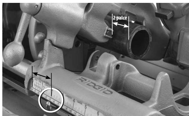
**Obrázek 20B – Ukazovátko délkového kalibru na požadované délce**
