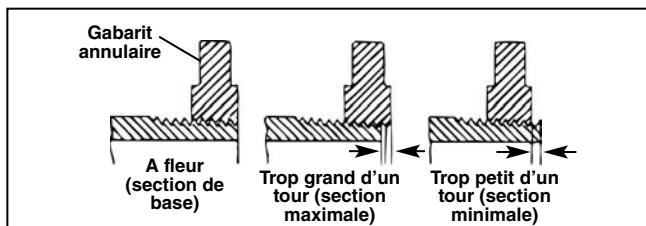
Figure 27 – Contrôle de la section du filetage
