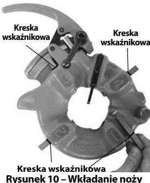
Rysunek 10 – Wkładanie noży
