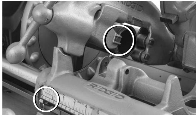
Obrázok 20A – čepel kolieska rezáka na konci rúry.
