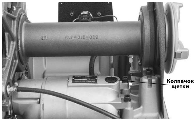
Рис. 34 – Снятие крышки электродвигателя/замена щеток
