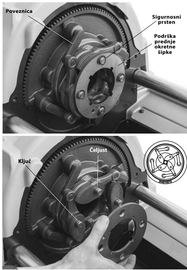
Slika 32 - Promjena čeljusti stroja s automatskom steznom glavom
