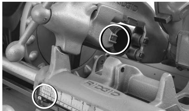
Slika 20A – Oštrica reznog točka naspram kraja cevi.
