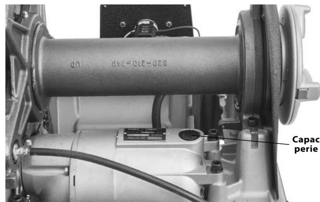
**Figura 34 – Demontarea capacului motorului/schimbarea periilor**
