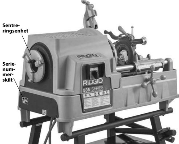
**Figur 1B – 535 Gjengemaskin med manuell chuck**
