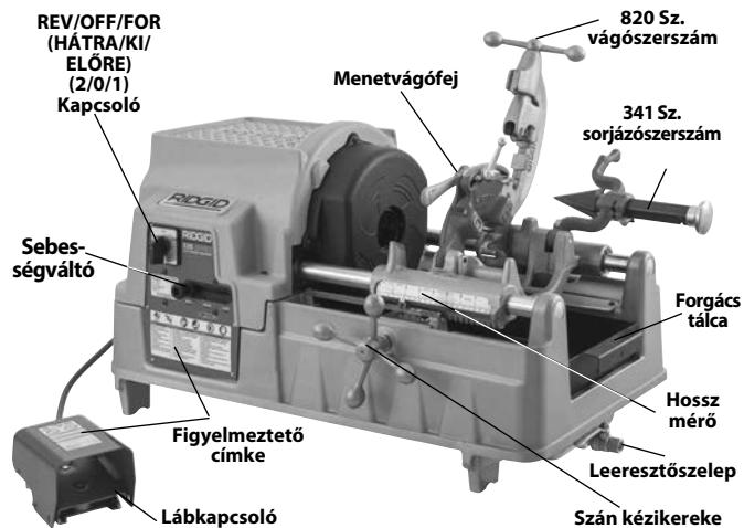
2A Ábra – 535 Automata tokmányos menetvágó gép
