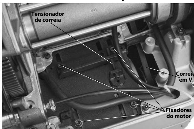
**Figura 35 – Tensionamento da correia**
