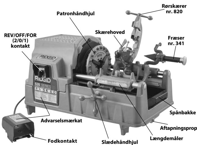
Figur 1A – 535 Gevindskærer maskine med manuel patron
