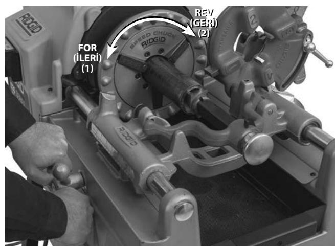
**Şekil 22 – Rayba İle Borunun Raybalanması, Makine Dönüşü**
