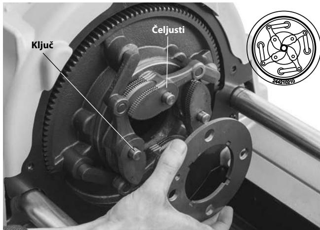
**Slika 32 - Zamenjava čeljusti na napravah s samodejno vpenjalno glavo**
