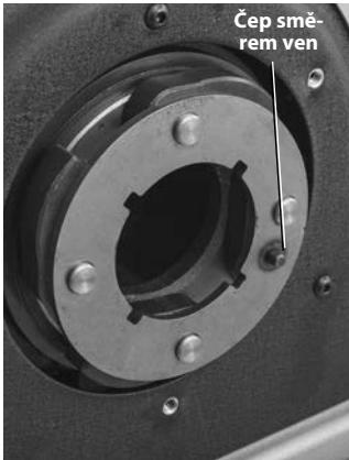
**Obrázek 25B – Zadní podpěra otočné osy - umístění čepu****Pravotočivé Řezání závitů**
