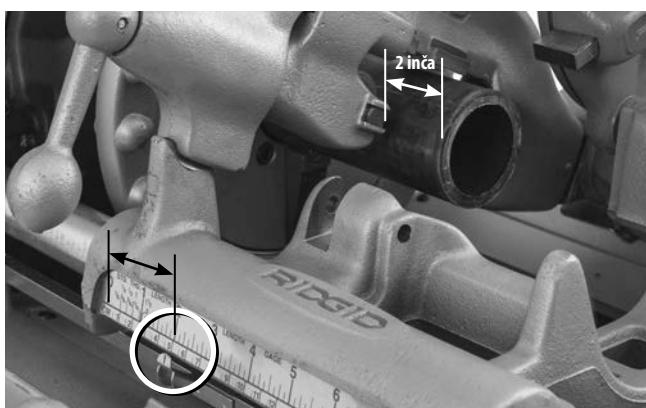
Slika 20B - Kazalnik merilnika dolžine na želeni dolžini
