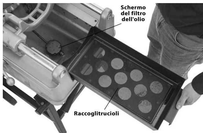
Figura 30 – Rimozione del raccoglitrucioli
