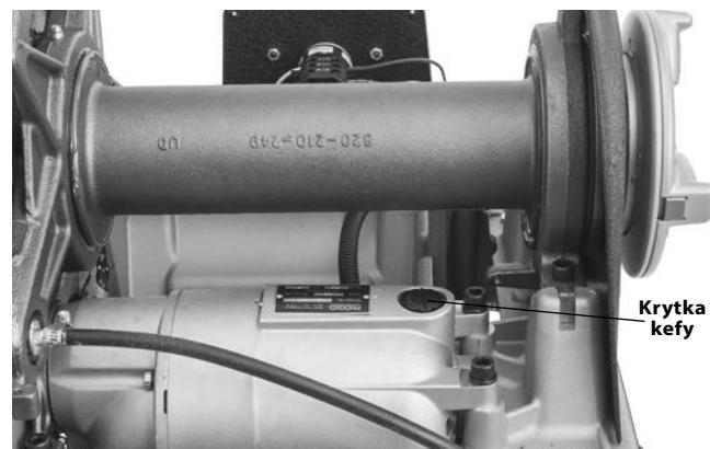
Obrázok 34 - Odstránenie krytu motora/výmena kief
