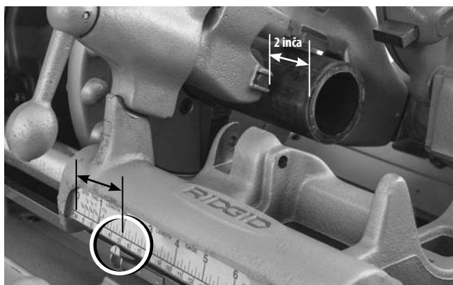
**Slika 20B - Pokazivač mjerača duljine na željenoj duljini**
