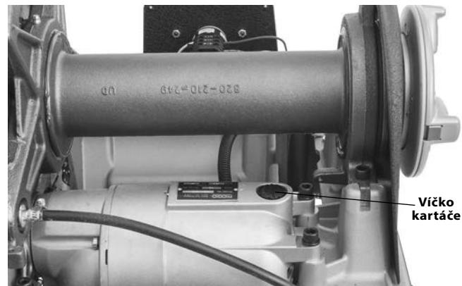
**Obrázek 34 – Demontáž krytu motoru/Výměna kartáčů**
