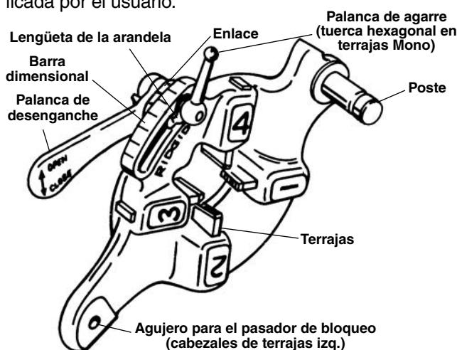
Figura 4 – Cabezal de terrajas de apertura rápida
