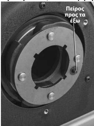
Εικόνα 25B – Πίσω στήριγμα άξονα - Τοποθέτηση πείρου
