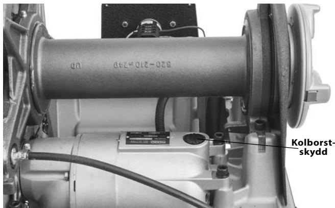
**Figur 34 – Byte av motorkåpa/kolborstar**
