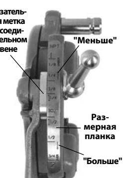
Рис. 7 – Настройка размера резьбы
