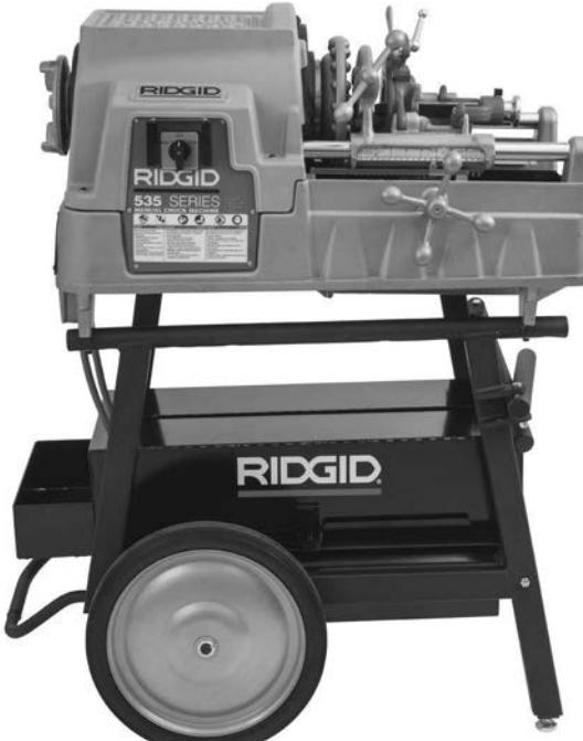
Slika 28 - Stroj pripremljen za prijevoz
