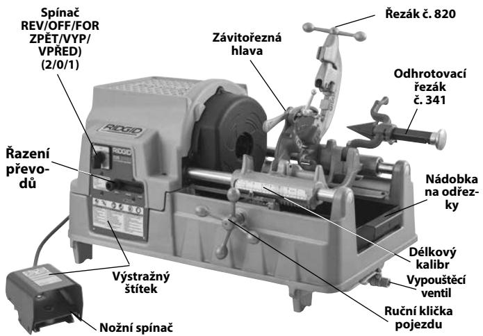
Obrázek 2A – 535 závitořezný nástroj s automatickým sklíčidlem
