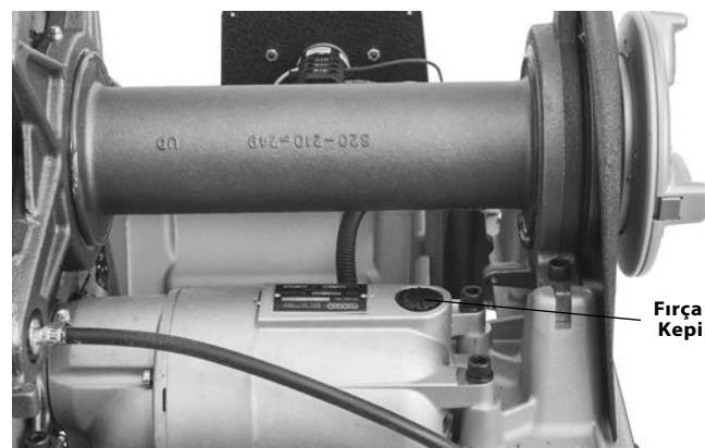
Şekil 34 – Motor Kapağının Çıkarılması/Fırçaların Değiştirilmesi
