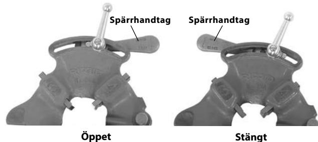
Figur 5 – Spakposition öppen/stängd
