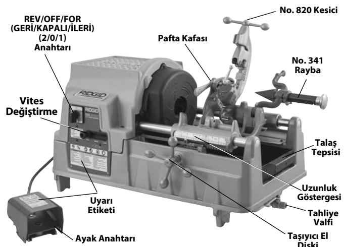
Şekil 2A – 535 Otomatik Ayna Diş Açma Makinesi
