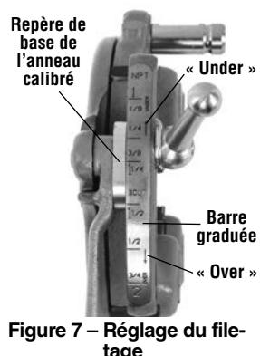
**Figure 7 – Réglage du filetage**
