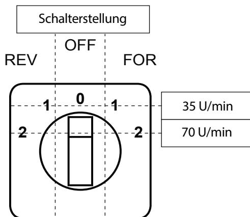
**Abbildung 19 – Drehzahl- und Richtungsregelung,
