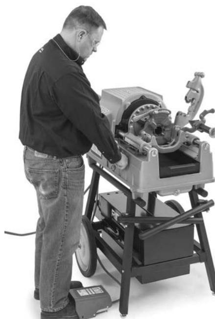
Figura 17 – Posição de funcionamento
