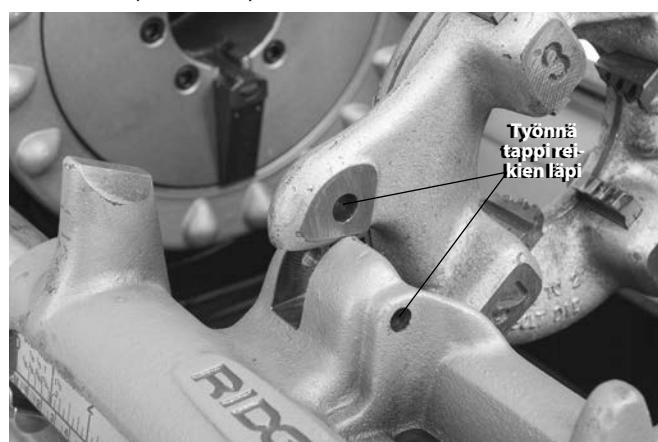
**Kuva 26 – Vasenkäisen kierrepään kiinnitys paikalleen**
