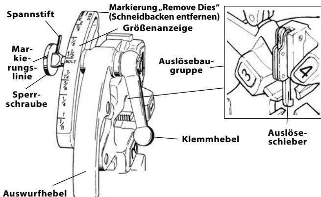
**Abbildung 8 – Selbstöffnender Universal-Schneidkopf**
