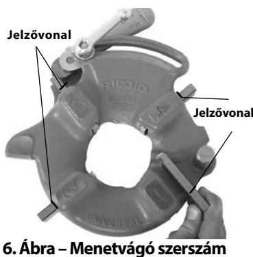
**6. Ábra – Menetvágó szerszám behelyezése**
