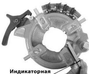
Рис. 14 – Установка резьбонарезных гребенок
