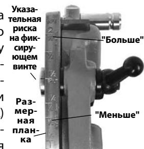
Рис. 11 – Настройка размера резьбы
