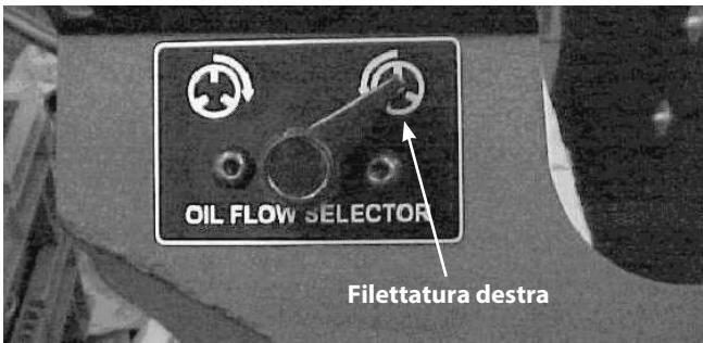
Figura 24 – Selettore del flusso dell'olio sinistro o destro
