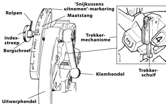
**Figuur 8 – Universele automatisch openende draadsnijkop**
