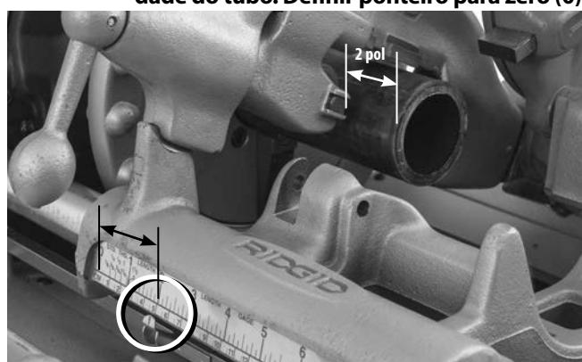
**Figura 20B - Ponteiro de medidor de comprimento no comprimento pretendido**
