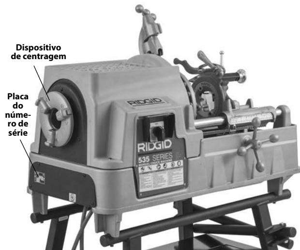
**Figura 1B - Máquina de roscar com mandril manual 535**
