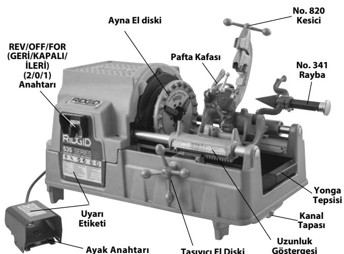
Şekil 1A – 535 Manuel Ayna Diş Açma Makinesi
