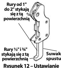
Rysunek 12 – Ustawianie spustu
