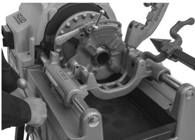
Figur 23 – Gjenging av rør
