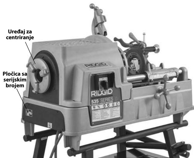
**Slika 1B - 535 Stroj za narezivanje s ručnom steznom glavom**
