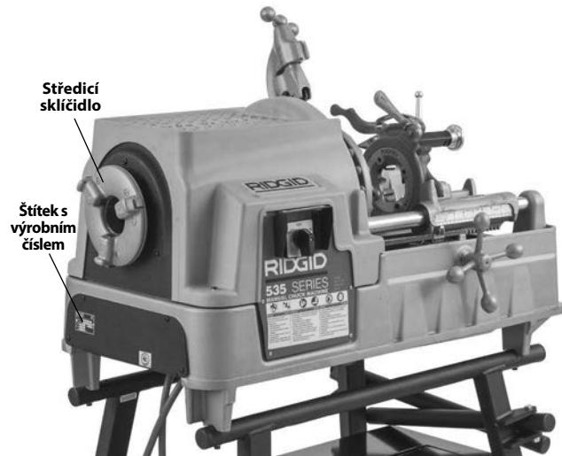
Obrázek 1B – 535 závitořezný nástroj s manuálním sklíčidlem
