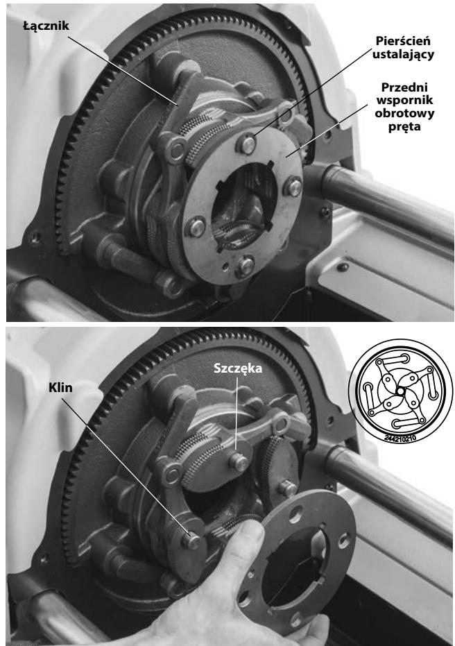
**Rysunek 32 – Wymiana szczek maszyny z uchwytem automatycznym**
