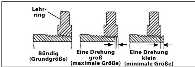
Abbildung 27 – Überprüfen der Gewindegöße
