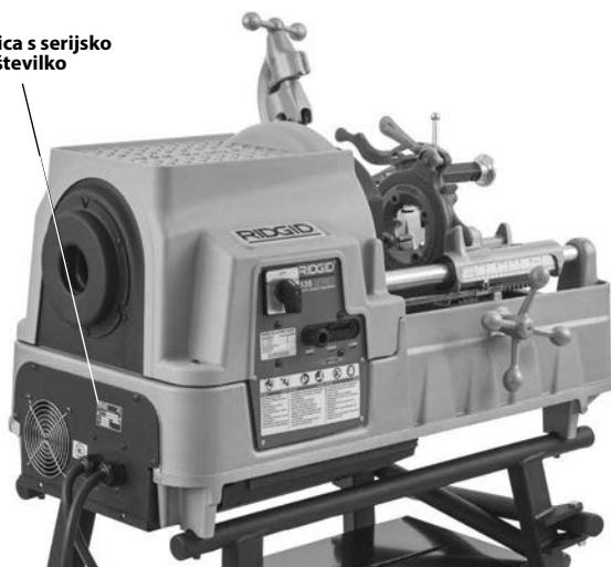
Slika 2B – 535 Naprava za rezanje navojev s samodejno vpenjalno glavo
