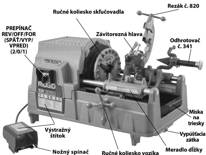
Obrázok 1A – Závitorez 535 s manuálnym sklučovadlom
