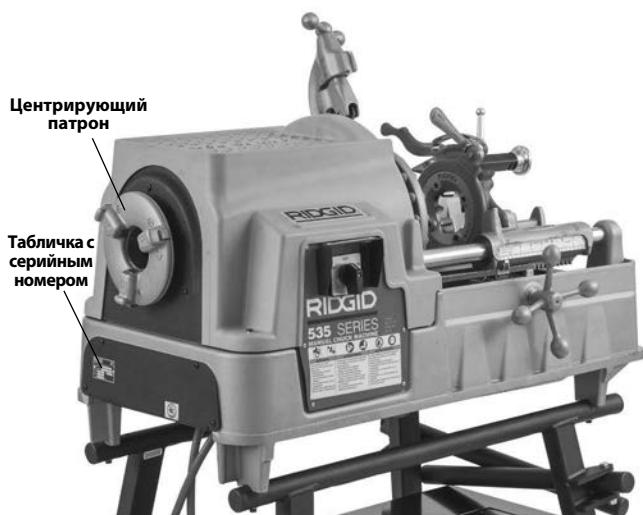
Рис. 1В – Резьбонарезной станок мод. 535
