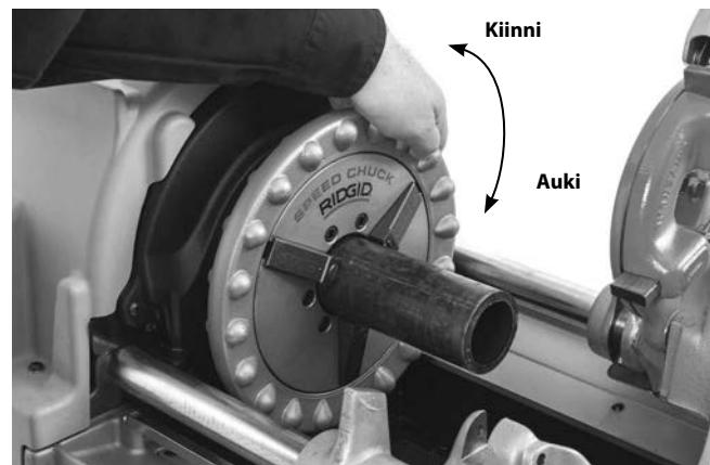
Kuva 16 – Putken kiinnitys
