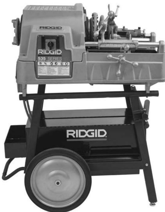
Figuur 28 – Machine klaargemaakt voor transport
