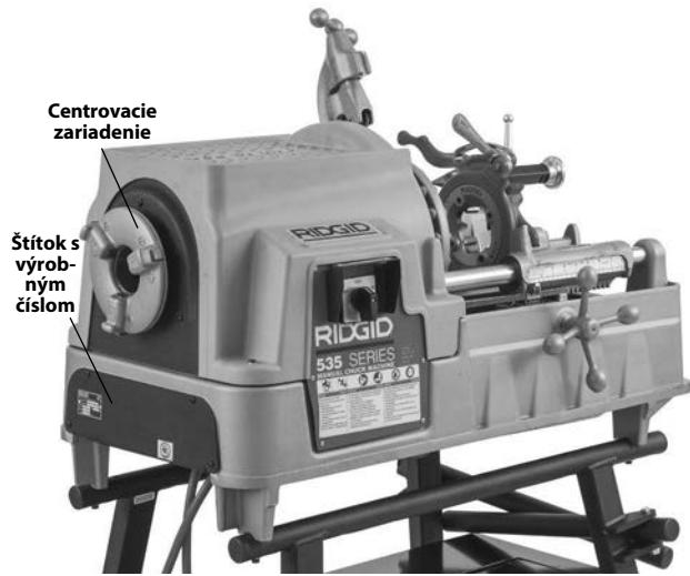
Obrázok 1B – Závitorez 535 s manuálnym sklučovadlom
