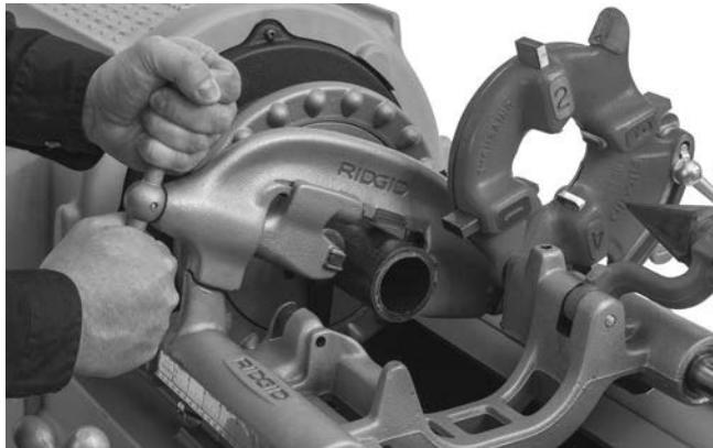
**Figura 21 - Cortar tubo com cortador**
