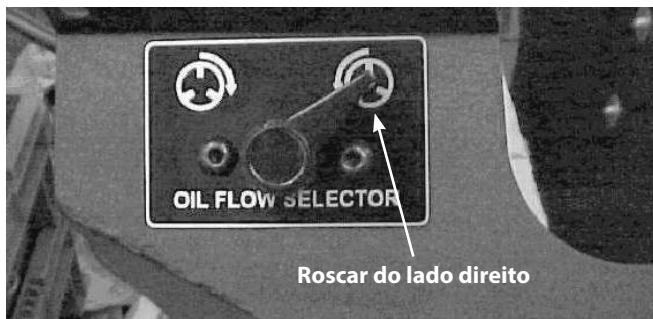
**Figura 24 – Seletor do fluxo do óleo do lado direito ou esquerdo**
