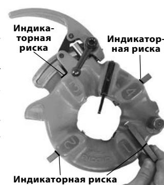
Рис. 10 – Установка резьбонарезных гребенок
