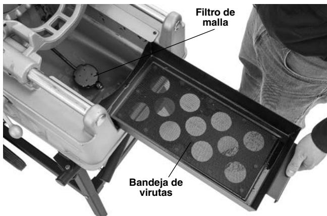
Figura 30 – Extracción de la bandeja de virutas
