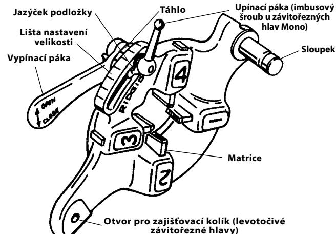
Obrázek 4 – Rychlootevírací závitořezná hlava
