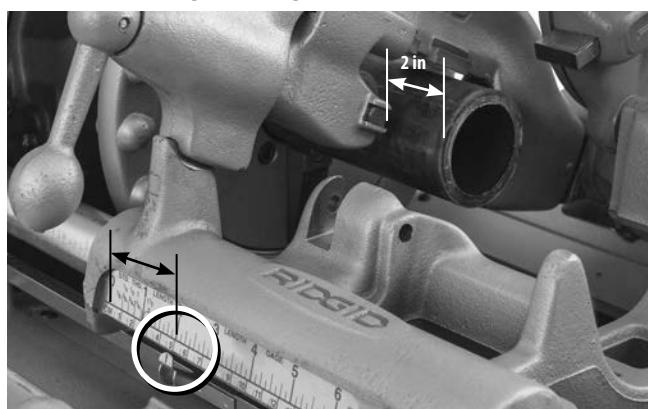
**Figur 20B – Lengdemålingspeker på ønsket lengde**
