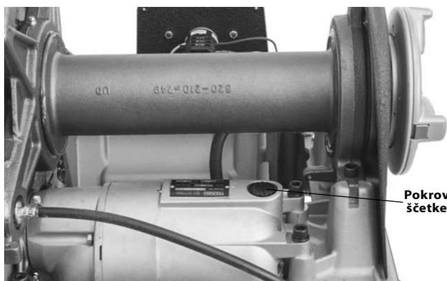
Slika 34 - Odstranjevanje pokrova motorja/zamenjava ščetk
