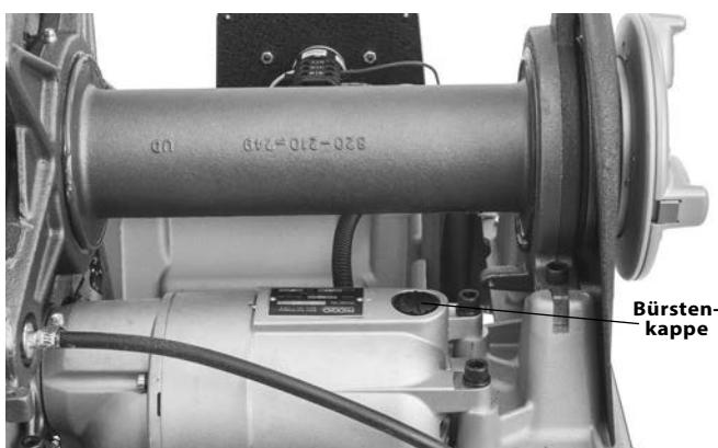
**Abbildung 34 – Ausbau der Motorenabdeckung/Austausch der Bürsten**
