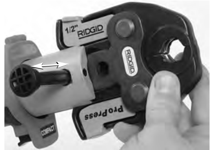
Figura 6 – Pasador de montaje de accesorios
