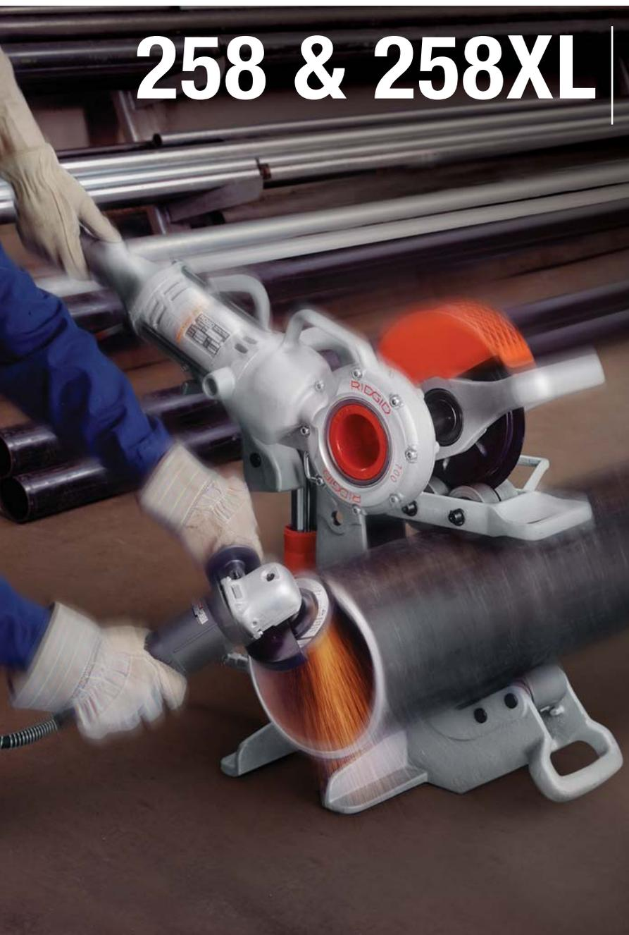
Les coupe-tubes électriques RIDGID® sont spécialement conçus pour couper les tubes rapidement, proprement et avec un minimum d'effort. Leur conception unique intègre le moteur RIDGID 700 qui commande la rotation d'une molette. Le modèle 258 permet de couper des tuyaux de 4" en moins de 60 secondes.
