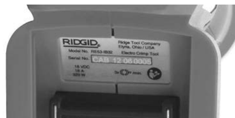
Slika 4 - Serijski broj stroja - prve 4 znamenke (zaokružene) označavaju godinu i mjesec proizvodnje. (12 = godina, 06 = mjesec).
