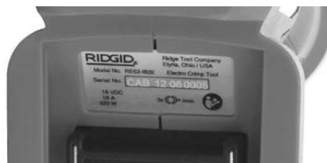
Slika 4 – Serijski broj mašine - Prve 4 cifre (zaokružene) pokazuju godinu i mesec proizvodnje. (12 = godina, 06 = mesec).
