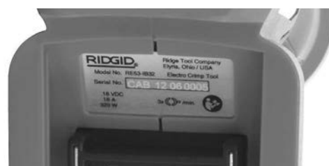
Figuur 4 – Serienummer van het apparaat – De eerste vier cijfers geven het jaar en de maand van productie aan. (12 = jaar, 06 = maand).
