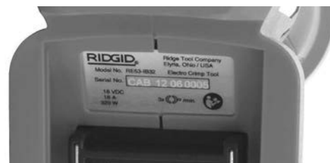
Εικόνα 4 – Σειριακός αριθμός μηχανήματος - Τα πρώτα 4 ψηφία (κυκλωμένα) υποδεικνύουν το έτος και τον μήνα κατασκευής. (12 = έτος, 06 = μήνας).
