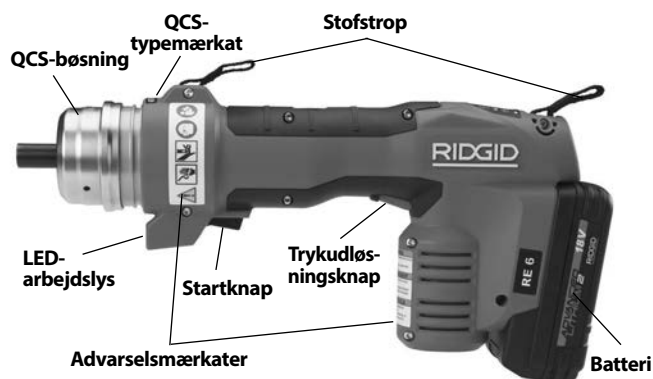
Figur 1 – RE 6/RE 60 - Brug QCS-koblingen til fastgørelse af hovedet
