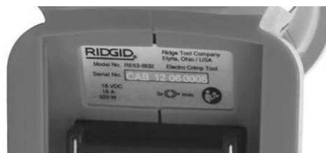
Figura 4 – Numero di serie della macchina - Le prime 4 cifre (cerchiate) indicano l'anno e il mese di produzione. (12 = anno, 06 = mese).
