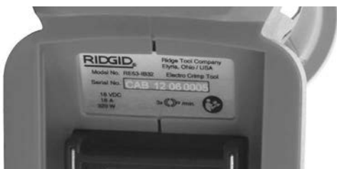
Figura 4 – Numărul de serie al mașinii - Primele 4 cifre (incercuite) indică anul și luna fabricației. (12 = anul, 06 = luna).
