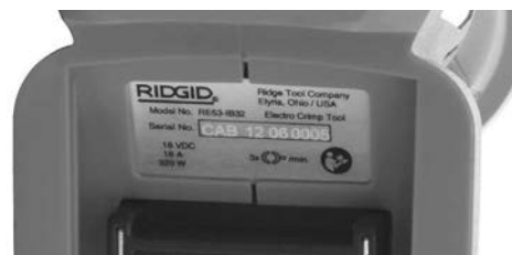
Obrázek 4 – Sériové číslo nástroje - První 4 číslice (zakroužkované) značí rok a měsíc výroby. (12 = rok, 06 = měsíc).
