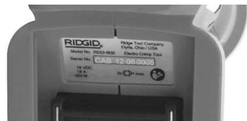
Rysunek 4 – Numer seryjny maszyny - Pierwsze 4 cyfry (otoczone kółkiem) wskazują rok i miesiąc produkcji. (12 = rok, 06 = miesiąc).
