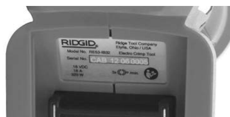
Figur 4 – Verktøyets serienummer - De første fire sifrene (innringet) viser året og måneden verktøyet ble produsert. (12 = år, 06 = måned).
