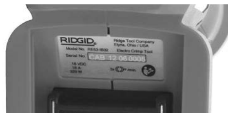
Figur 4 – Maskinens serienummer – De 4 första siffrorna (inringade) anger tillverkningsår och tillverkningsmånad. (12 = år, 06 = månad).
