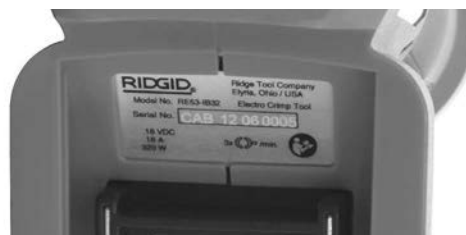
Figur 4 – Maskinens serienummer - De 4 første cifre (omkranset) viser produktionsår og -måned. (12 = år, 06 = måned).
