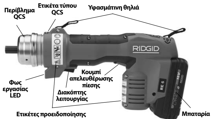
Εικόνα 1 – RE 6/RE 60 - Χρήση σύνδεσης QCS για σύνδεση κεφαλής
