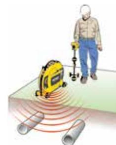
Induzieren eines Signals zur Lokalisierung von Versorgungsleitungen
