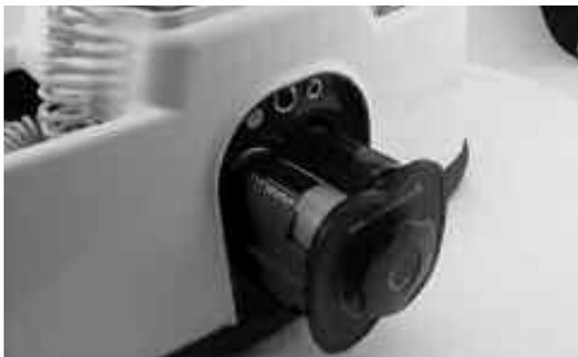
Abbildung 6 – Herausnehmen des Batteriefachs
