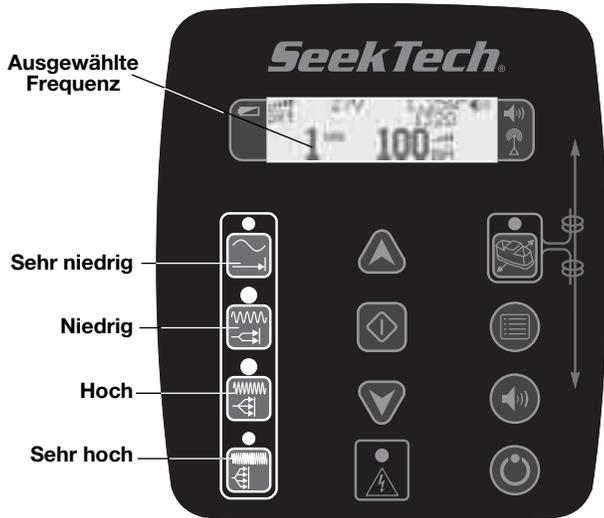
Abbildung 19 – Frequenzstasten – Empfänger/Ortungsgärts anderer Hersteller
