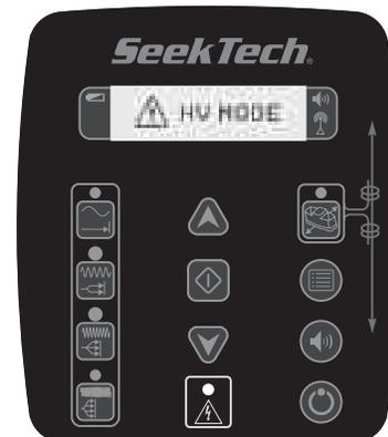
Abbildung 9 – Hochspannungsanzeige
