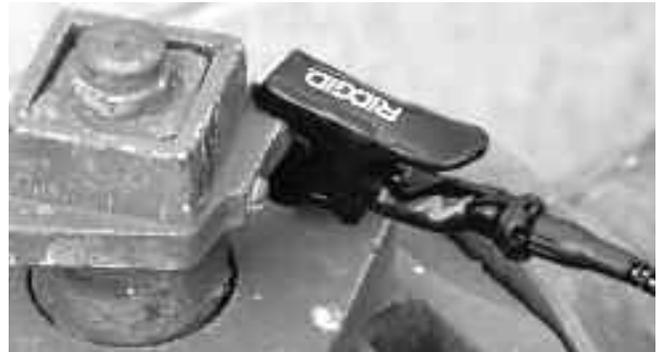
Abbildung 8 – Anschluss des Kabelkontakts an den Zielleiter
