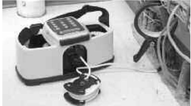
**Abbildung 12 – An einen Leiter angebrachte Induktionsklammer**
