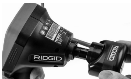
Εικόνα 18 - Βύσμα σύνδεσης κάμερας τοποθετημένο
