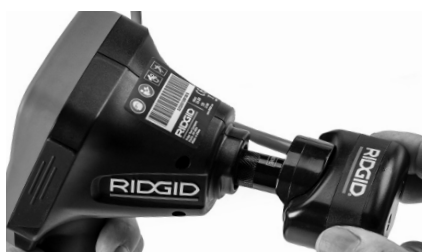
Slika 18 - Montirani priključni utikač kamere
