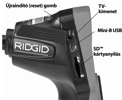
4. ábra – Bal oldali csatlakozó-burkolat
