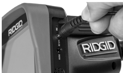
Rys. 6 - Zasilanie zespołu z zasilacza prądu przemiennego
