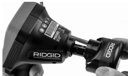
Figuur 18 – Cameraverbindingsstekker geïnstalleerd
