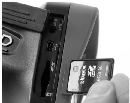
**Abbildung 9 - Einsetzen der SD-Karte**
