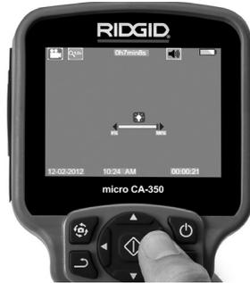
**Figura 14 – Ajuste de los LED**
