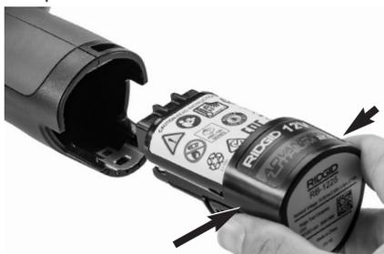
Figura 5 – Extracción e instalación de la batería
