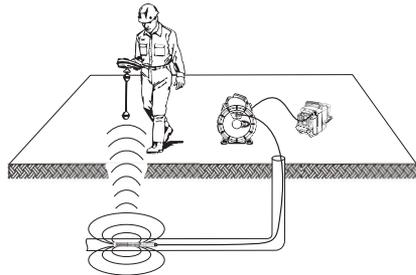
Figure 19 – Localisation de la sonde de l'enrouleur
