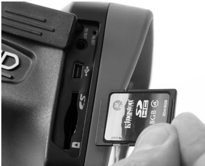
Figura 9 – Introducción de la tarjeta SD
