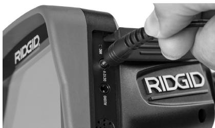
Figura 6 – Alimentación del aparato con el adaptador CA
