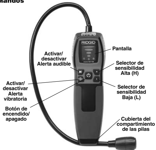
Figura 2 – Piezas y botones del micro CD-100
