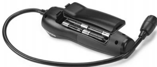
Figure 4 – Retrait du couvercle du logement de piles
