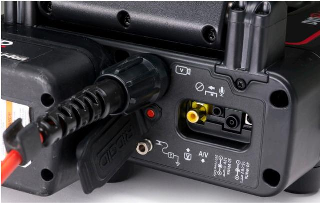
Figura 4 – Conectando el Cable del Sistema SeeSnake al DVDPak2
