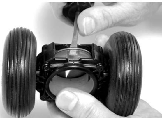
Figure 20 – Ouverture des cerclip du chariot à roues
