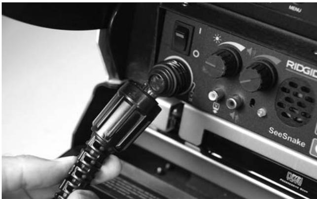
Figure 23 – Alignement de la fiche du câble de connexion
