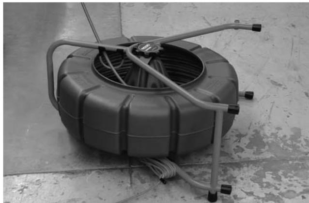
**Figure 22 – L'enrouleur peut être couché sur son dos pour une meilleure stabilité.**
