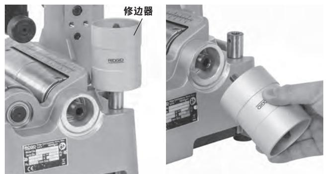
图 11 - 安装修边器
