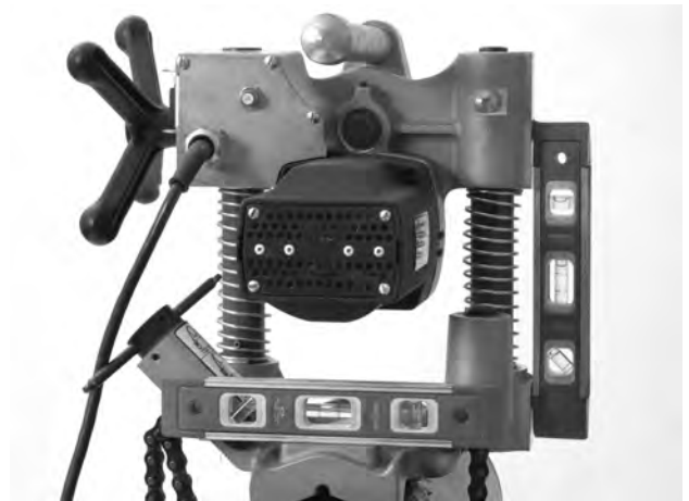
Figura 10 – Nivelación de la HC-300
