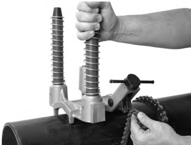
Figure 8 – Accrochage de la chaîne
