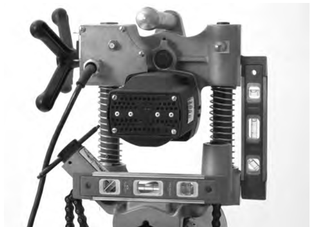
Figure 10 – Mise de niveau de la HC-300
