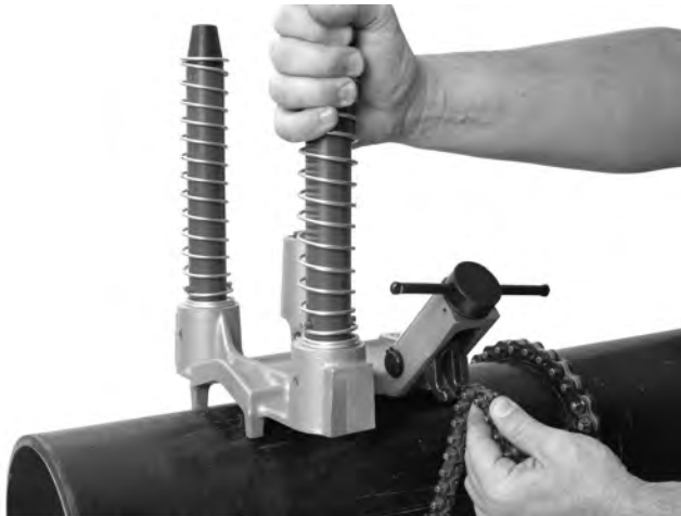
Figura 8 – Enganche de la cadena de la HC-300
