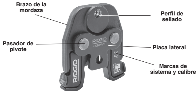
Figura 1 – Mordazas de sellado RLS para sistemas de refrigeración
