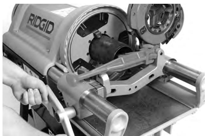
**Abbildung 22 – Fräsen des Rohrs mit dem Innenrohrfräser**
