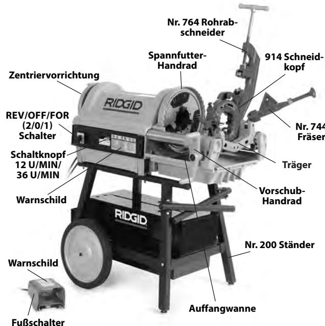
Abbildung 1 – Geschwindeschneidmaschine 1224
