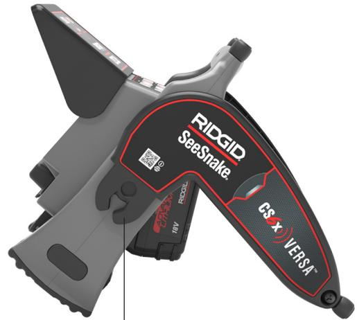
2. CS6x ヴァーサをドッキングフィンにの中心に配置し、ドッキングジョイントをジョイントソケットに合わせます。
