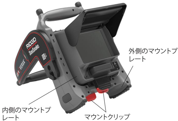
CS6x ヴァーサは、内側と外側のマウントプレートのどちらにも取り付けることができます。取付位置を変更することにより、モニターの高さ調整が可能です。
