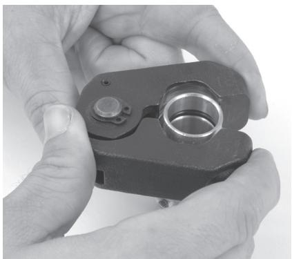
Abbildung 9 – Anbringen des Pressrings am Fitting
