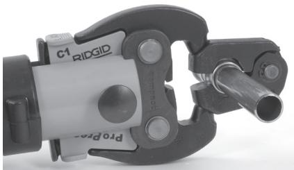
Abbildung 10 – Ansetzen der Ringbacke am Pressring
