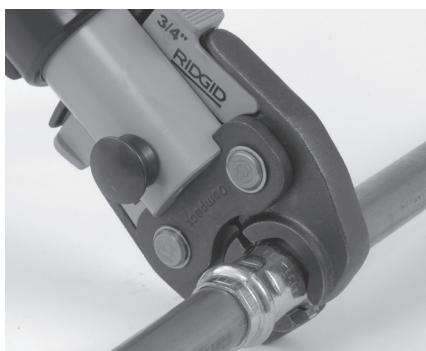
**Abbildung 7 – Anbringen Pressbacke an Fitting**
