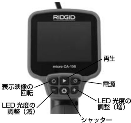
図 2 - コントロール部
