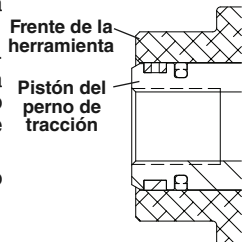
Figura 2 – Nivel de aceite bajo en el cabezal punzonador
