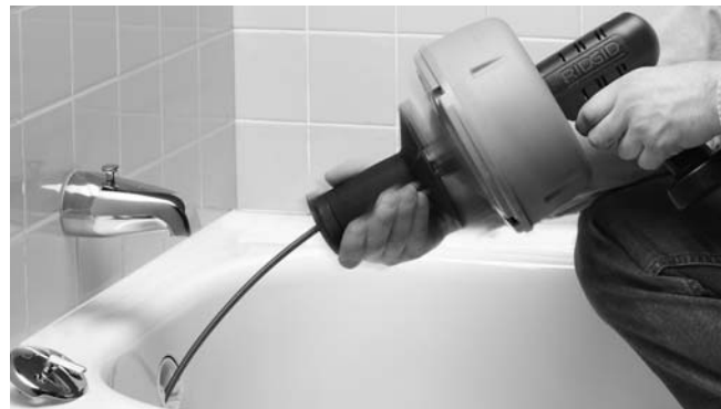
Figura 7 – Lleve la empuñadura HACIA DELANTE para desenganchar el embrague y extraiga más cable del tambor
