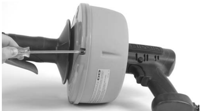
Figure 9 – Desserrez les quatre (4) vis de la partie arrière du tambour d'environ deux (2) tours.
