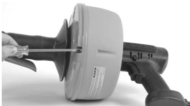
Figura 9 – Afloje los cuatro (4) tornillos en la mitad posterior del tambor unas tres (3) vueltas completas
