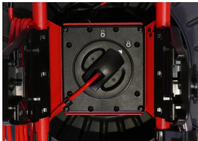
3. Legen Sie das Systemkabel in den Rahmenhaken und drücken Sie die Kabelklemme an den Rahmen.
