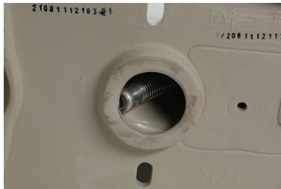
**Figure 16 – Tête de caméra bloquée dans une courbe**
