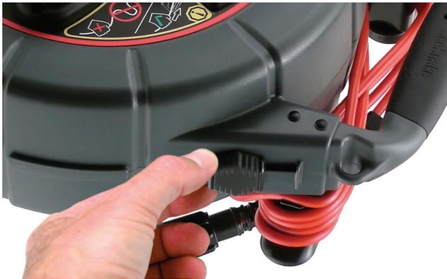
Figure 4 – Déverrouillage du boîtier du nanoReel
